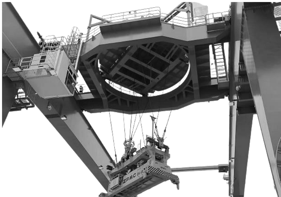
Slika 3. Okretno postolje s kotačima i tračnicama, [3]
