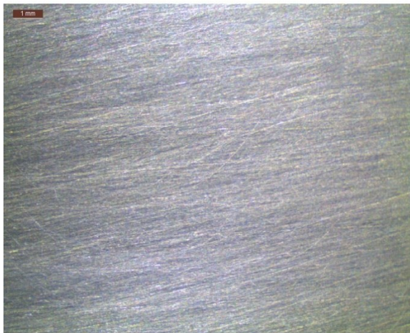
Slika 53. Snimke ispitnih uzoraka testiranih u običnoj vodi i destiliranoj otopini 0,4% NaCl
