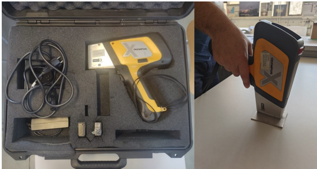
Slika 28. Uređaj XRF- Olympus DS 2000-C koji je korišten za ispitivanje kemijskog sastava ispitnih uzoraka te primjer njegovog korištenja
