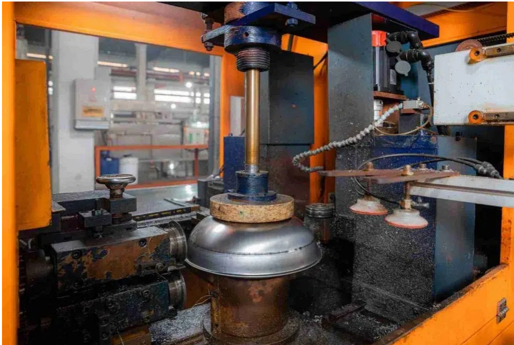
Slika 15. Strojno zaobljavanje rubova isprešanog dijela duboke tave od nehrđajućeg čelika [33]
