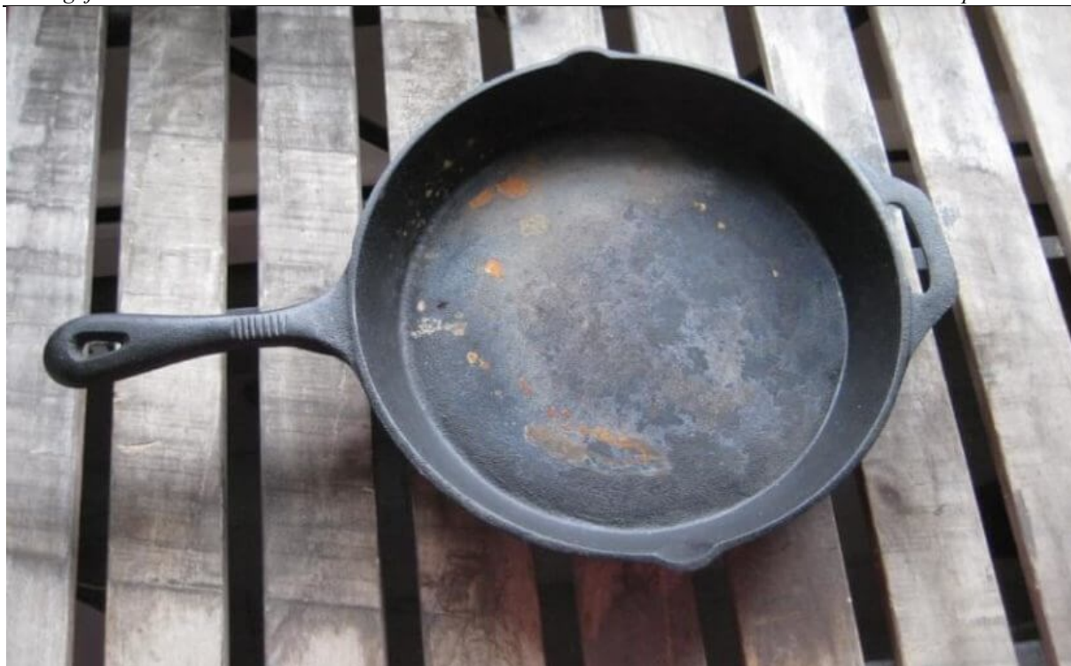
Slika 9. Korodirana posuda od lijevanog željeza [19]
