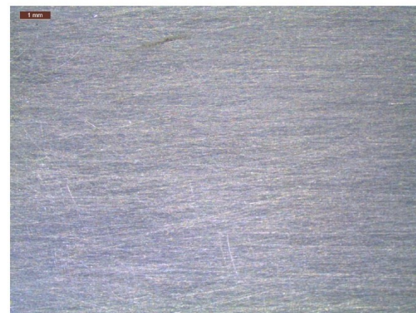
Slika 55. Snimke ispitnih uzoraka testiranih u razrijeđenom soku od rajčice i bademovom mlijeku
