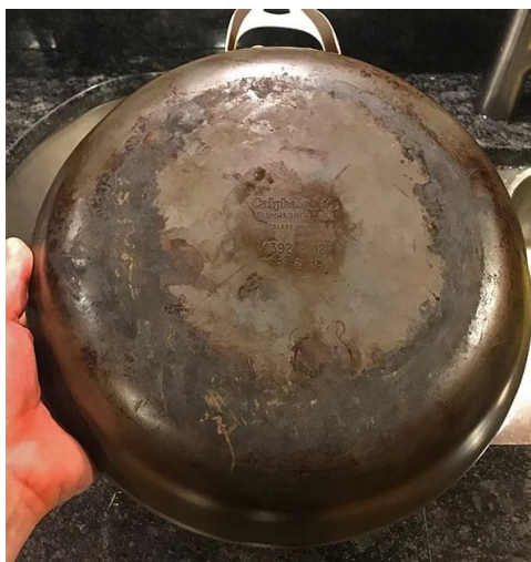
Slika 19. Stvaranje mrlja i diskoloracija na posuđu od anodiziranog aluminija zbog kuhanja na previsokoj temperaturi [10]
