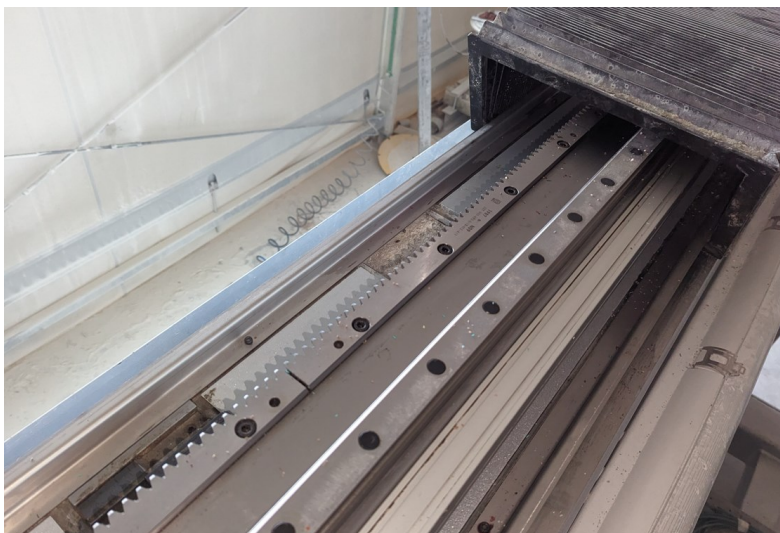
Slika 12. Vodilica, mjerna i zubna letva prigona Y osi
