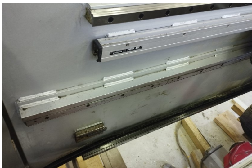
Slika 10. Vodilice, mjerna i zubna letva prigona X osi
