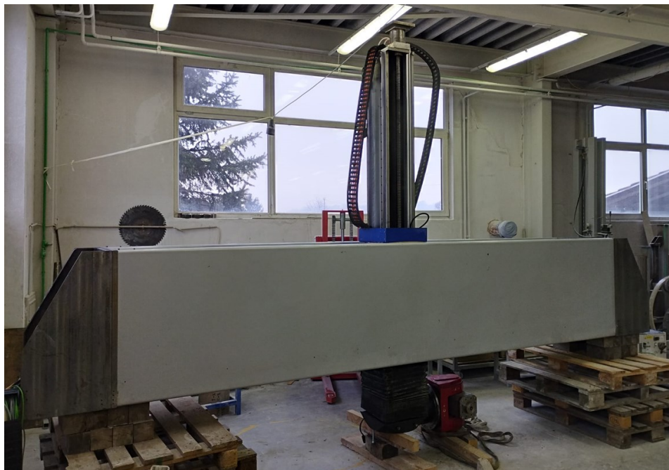
Slika 8. Sklop prigona posmičnih osi X, Y i Z (dio posmičnog prigona Y osi nije vidljiv na slici – radi se o zubnim letvama koje su na bočnim stranicama postolja)
