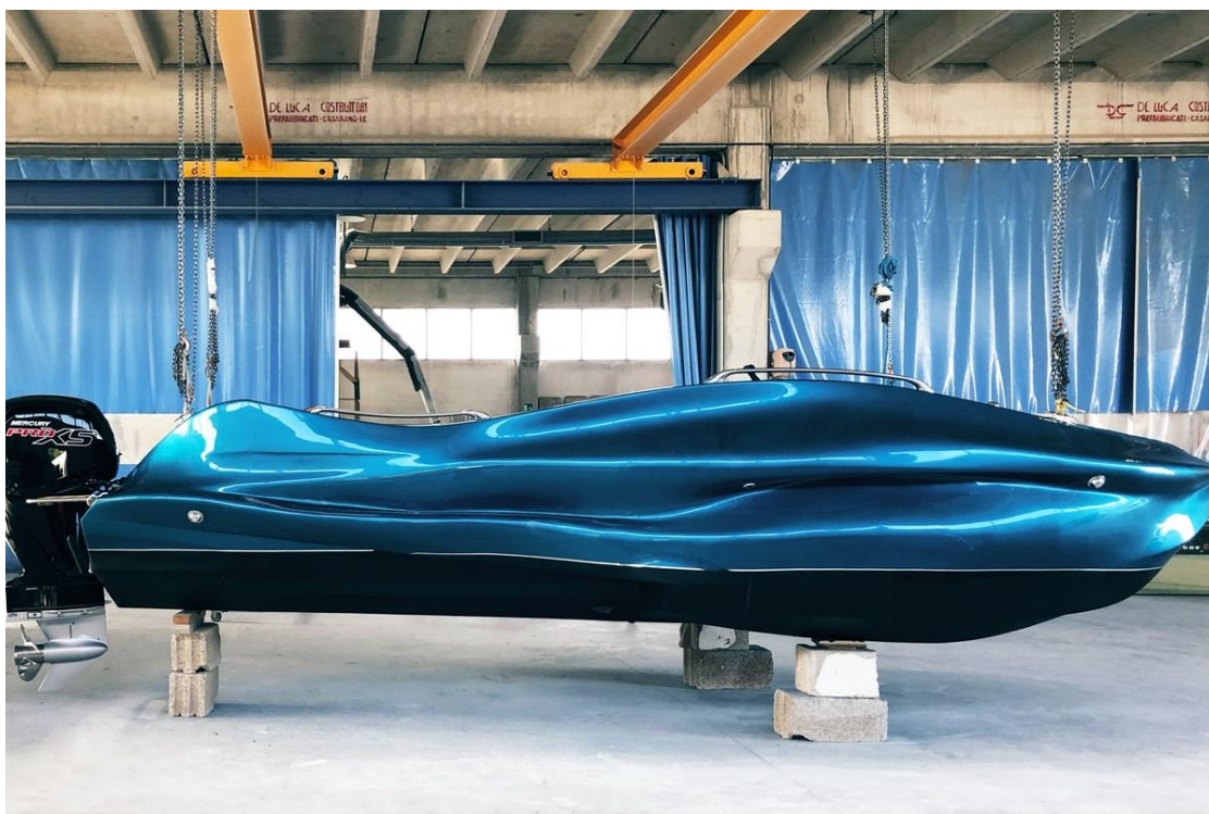
Slika 24. 3D ispisan gliser od staklenih vlakna [33]
