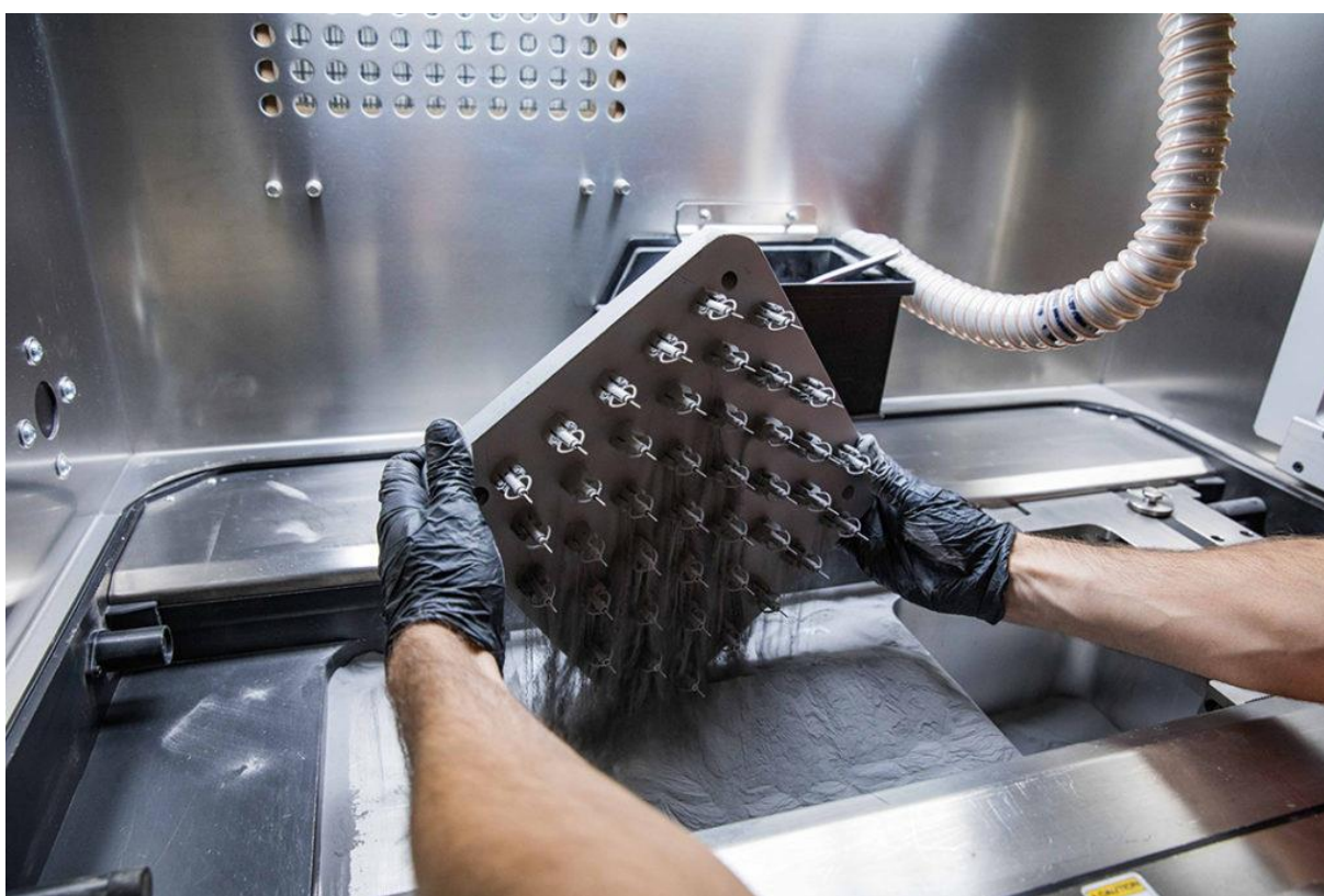
Slika 18. Modeli ispisani DMLS tehnikom [24]
