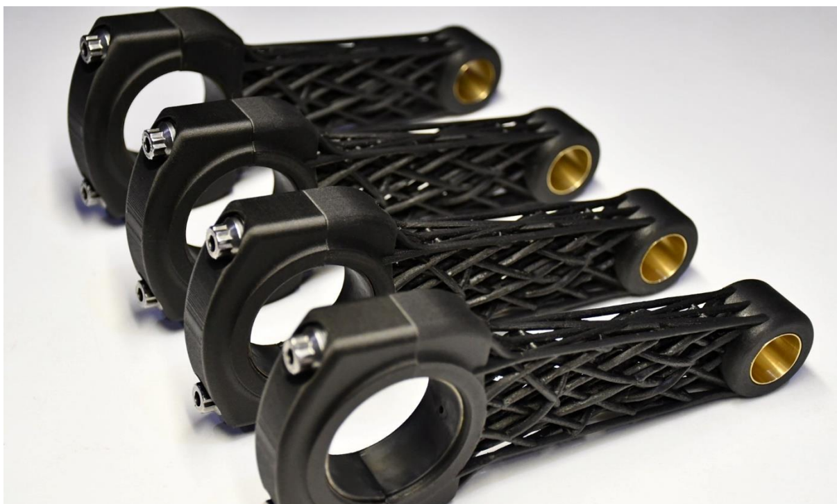
Slika 23. FDM tehnikom 3D ispisane spojne šipke [32]
