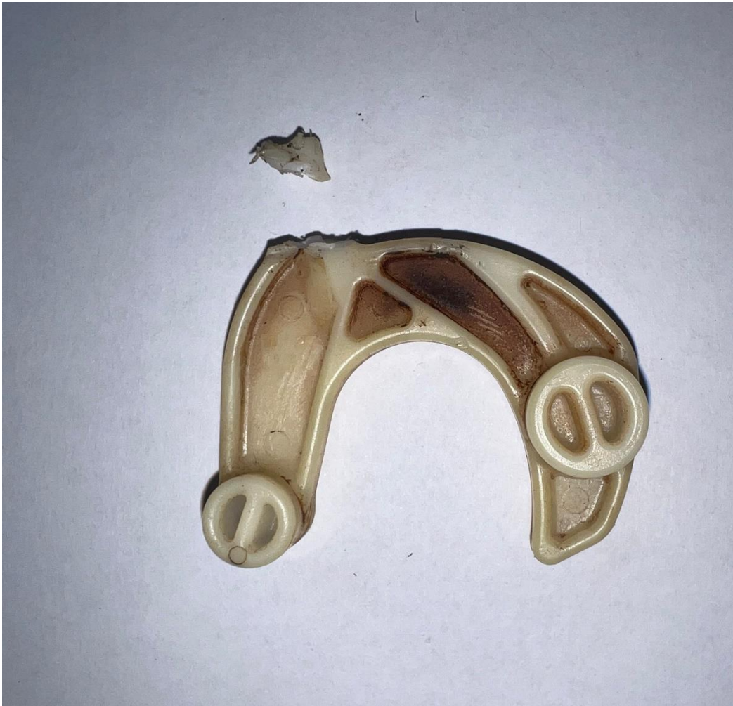
Slika 43. Prikaz neispravnog dijela uz odlomljeni dio
