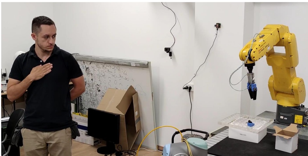
Slika 26. Korisnik miruje s fiksiranom rukom – testiranje najmanjih pokreta zbog šuma sustava (slika autora)
