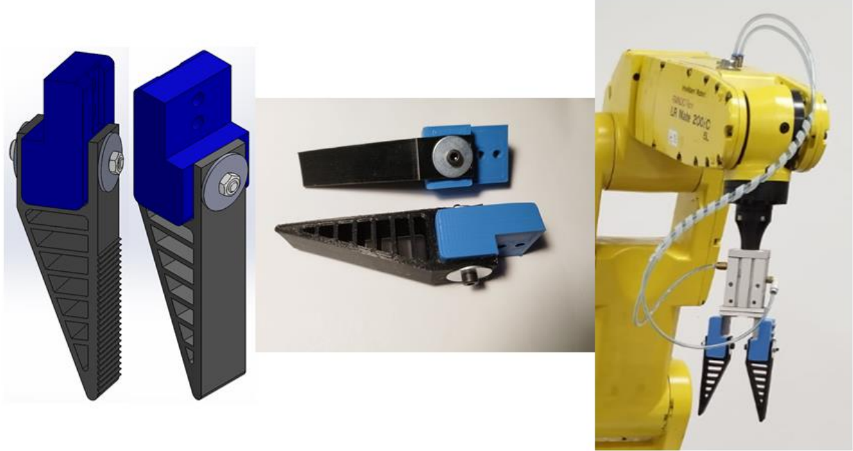
Slika 22. Model sklopa adaptivnih prstiju (lijevo), sastavljeni sklop (sredina) i montirani sklop adaptivnih prstiju na hvataljku robota (slika autora)
