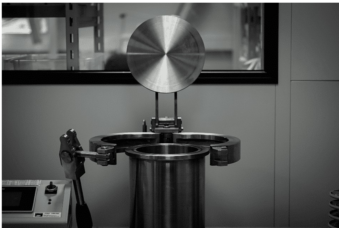
Slika 11. Prikaz tlačne komore za postizanje visokih tlakova u ispitivanju vodonepropusnosti [7]
