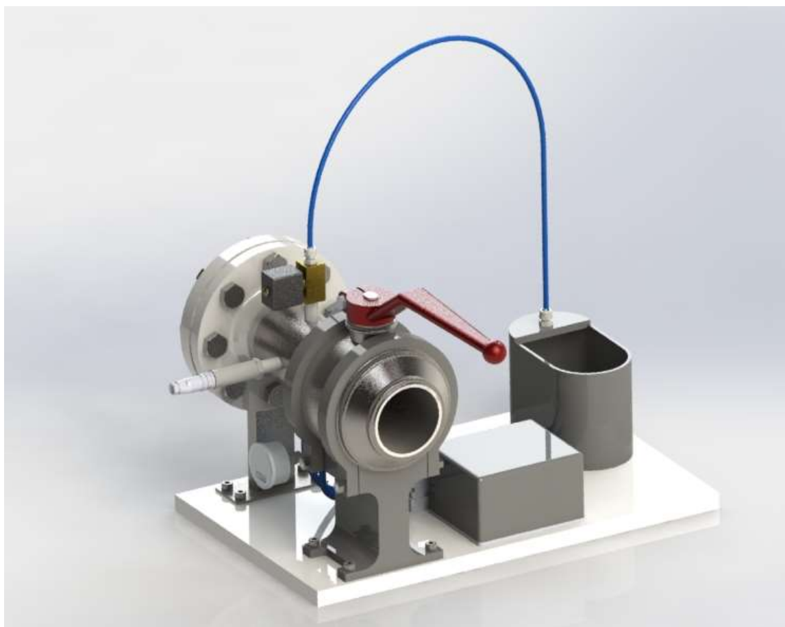
Slika 18. 3D vizualizacija tlačne komore
