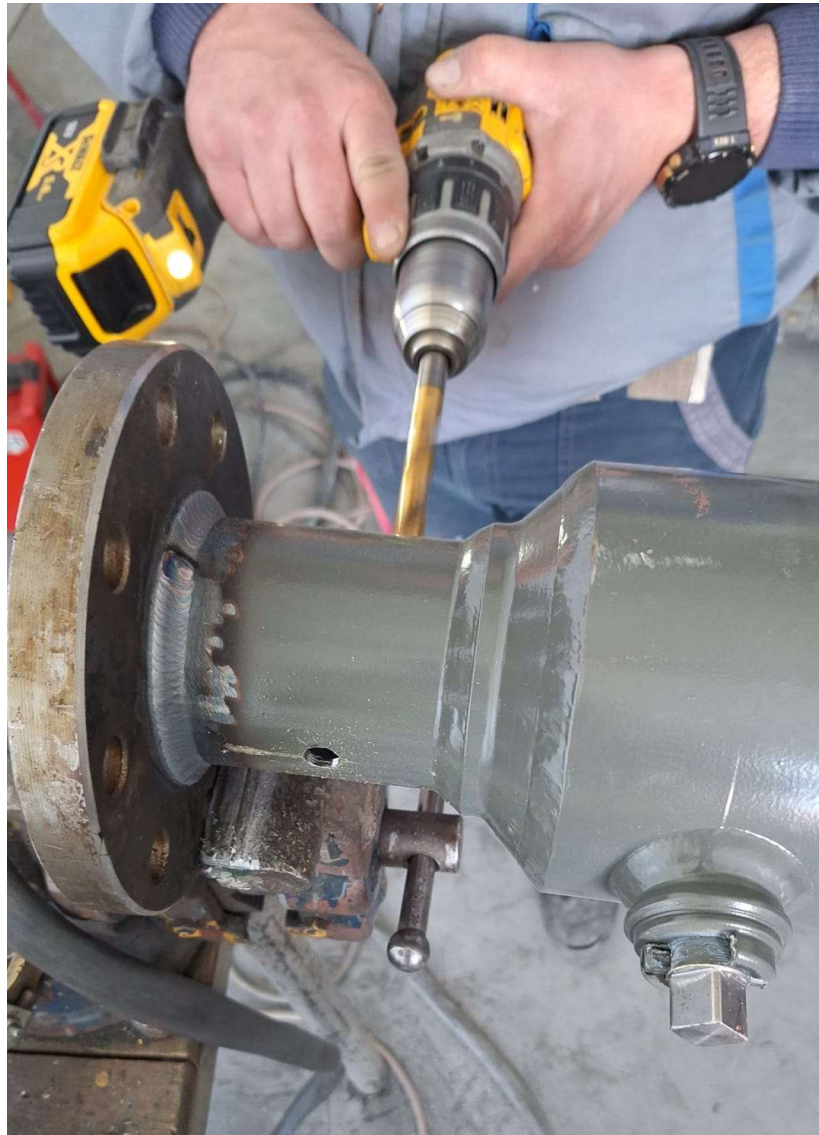
Slika 24. Izrada provrta za priključke s Whitworthovim navojem
