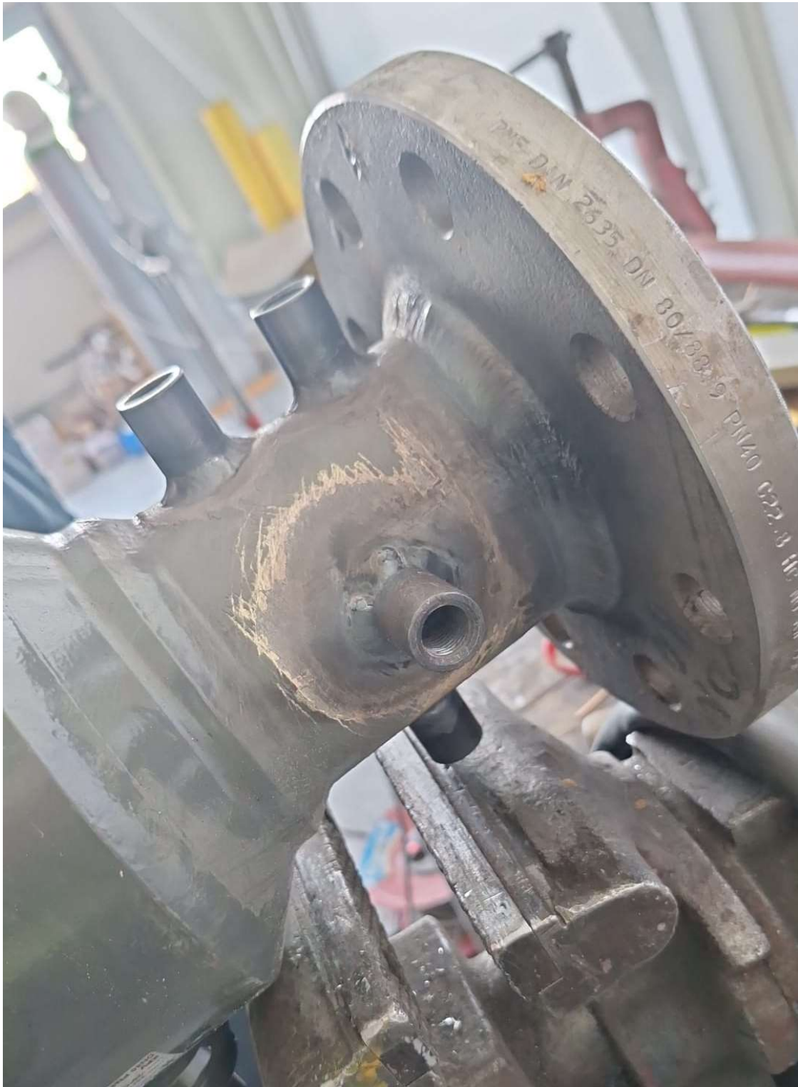
Slika 26. Zavareni priključci na tijelo ventila
