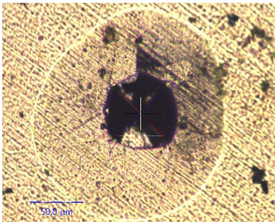
Slika 16. Otisak koji je probio prevlaku
