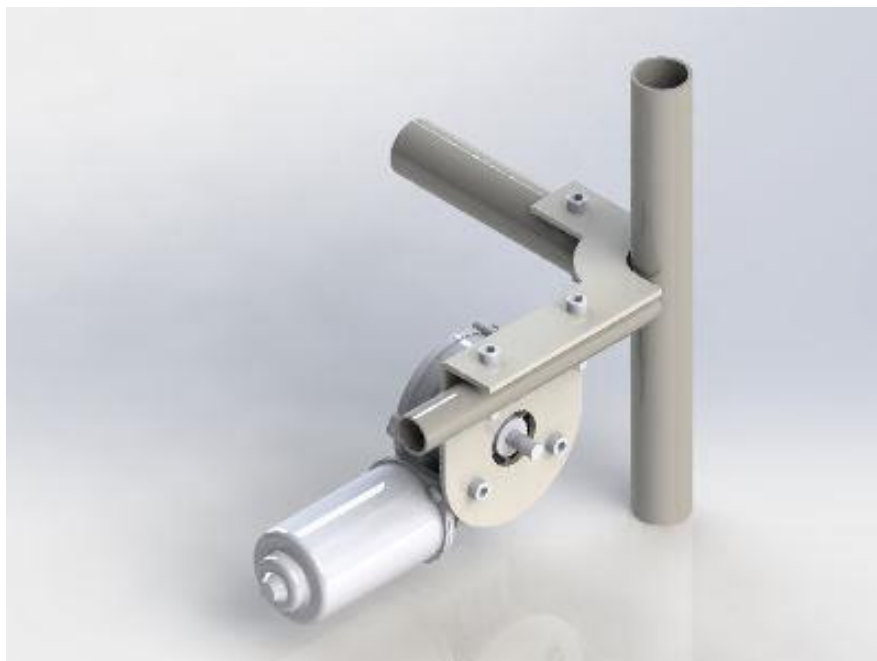
Slika 17. CAD model držača za motore
