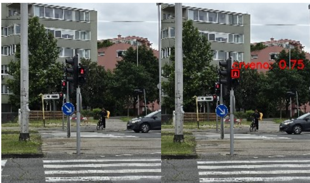
Slika 3.8 Usporedba inferencije na istoj slici s 3 različito podešena YOLOv8n modela (640x640 i 1440x1440 lijevo i 3008x3008 desno)
