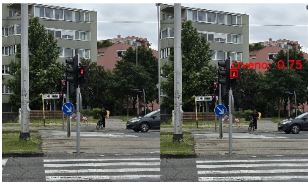
Slika 3.8 Usporedba inferencije na istoj slici s 3 različito podešena YOLOv8n modela (640x640 i 1440x1440 lijevo i 3008x3008 desno)
