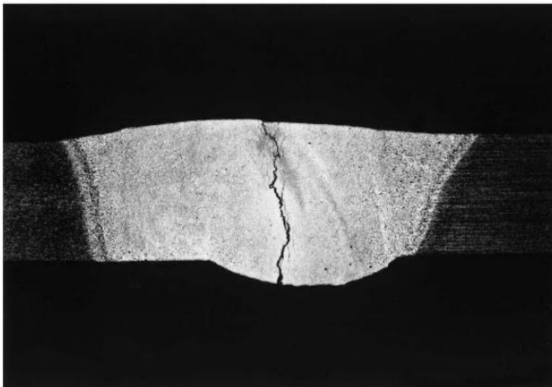
Slika 2. Prikaz tople pukotine nastale tijekom zavarivanja aluminijske legure [5]
