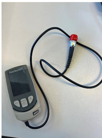
Slika 23. Uređaj PosiTector SHD za mjerenje tvrdoće
