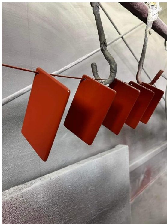
Slika 20. Nanošenje međupremaza na uzorke P i PX
