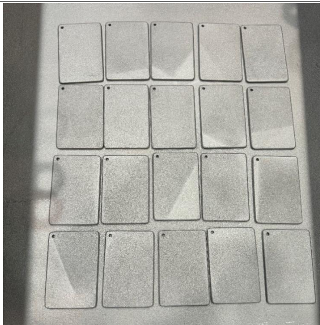
Slika 12. Pripremljeni uzorci od ugljičnog čelika S235
