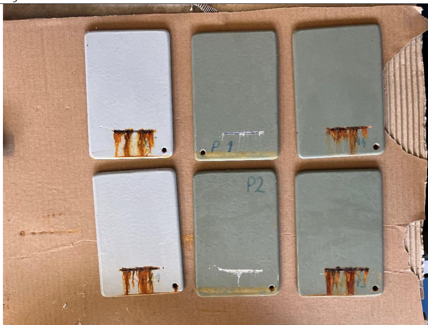
Slika 27. Uzorci nakon 720 h u slanoj komori (s lijeva na desno: PX, M i P)
