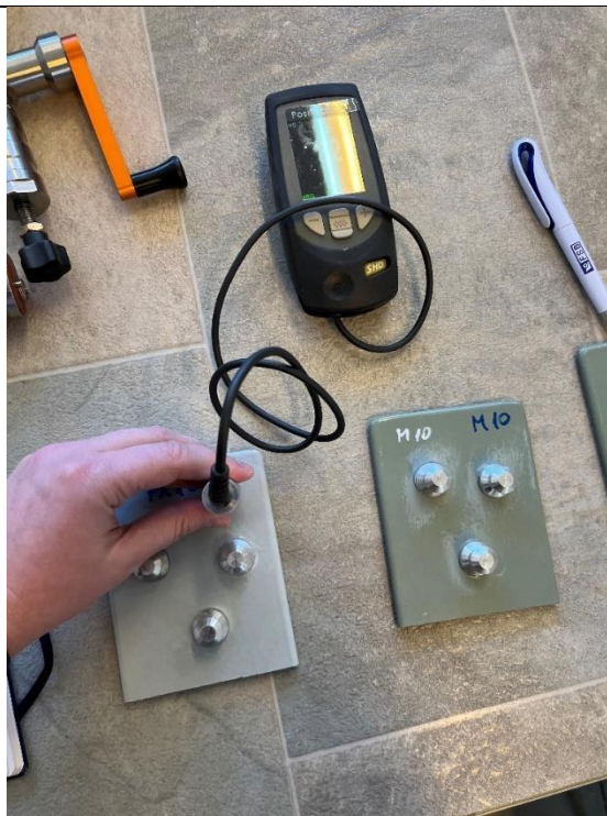
Slika 24. Mjerenje tvrdoće uzorka PX10
