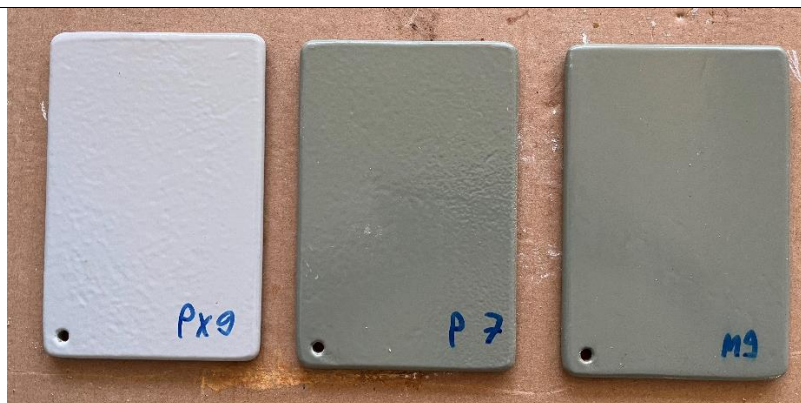
Slika 31. Uzorci nakon 960 sati u vlažnoj komori
