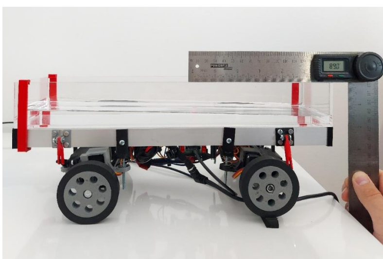
Slika 71. Mjera kuta horizontalnog brida vozila s tekućinom s bočne strane u odnosu na okomicu s neravnom kod stražnje osovine
