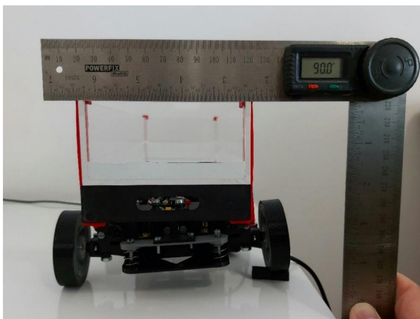
Slika 66. Mjera kuta horizontalnog brida vozila s tekućinom s prednje strane u odnosu na okomicu s neravninom kod prednje osovine
