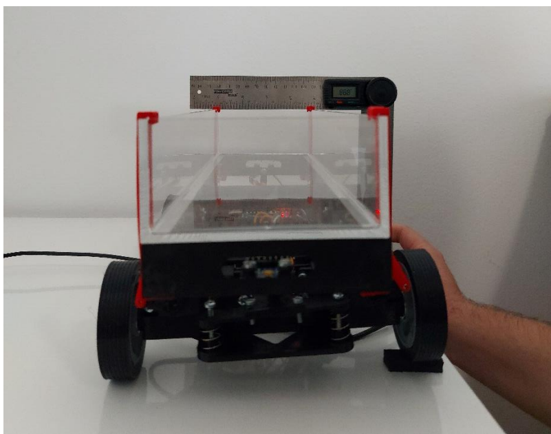
Slika 58. Mjera kuta horizontalnog brida vozila s prednje strane u odnosu na okomicu s neravnom kod stražnje osovine
