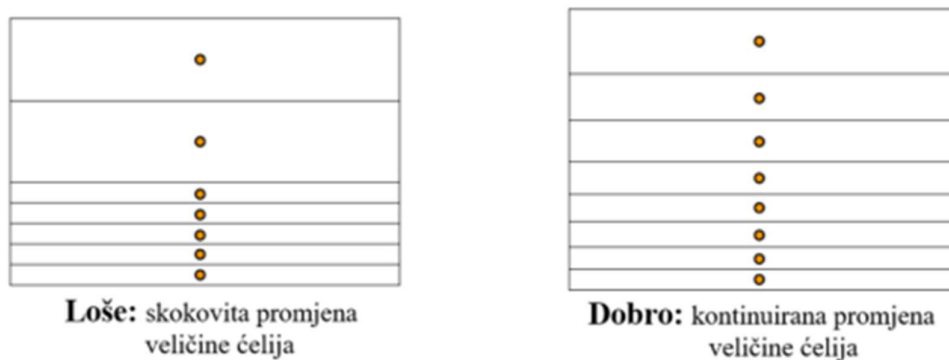
Slika 9. Dobra i loša diskretizacija graničnog sloja [27]
