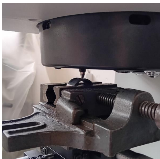
Slika 38. Mjerenje tvrdoće unutarnjeg prstena
