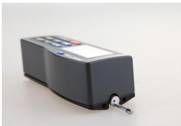
Slika 32. Uređaj za ispitivanje hrapavosti „TIME 3202“ [16]
