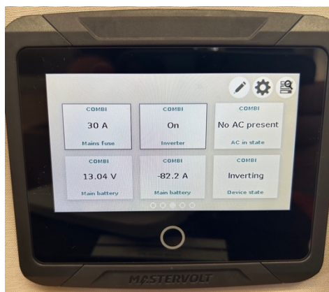
Slika 34. Potrošnja invertera pri radu klima uređaja u 2 kabine
