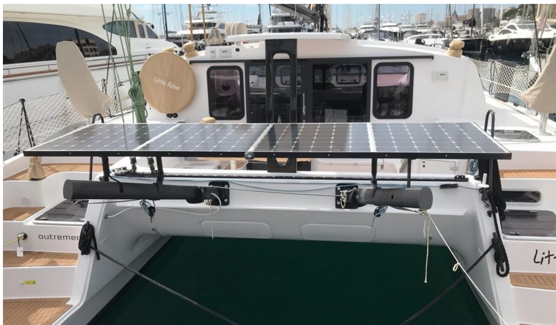
Slika 4. Montaža solarnih panela na krmu katamarana [6]
