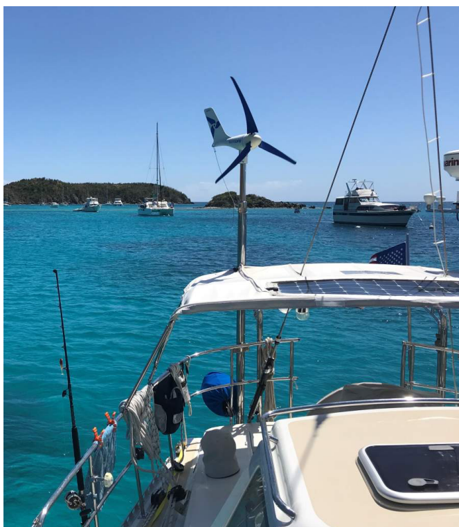
Slika 7. Montirana brodska vjetroturbina
