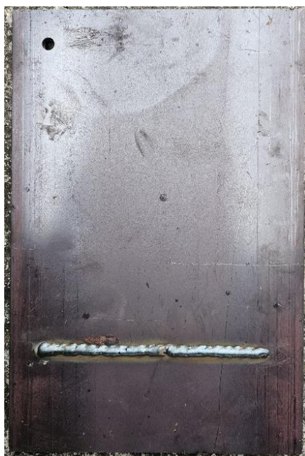
Slika 54. Uzorak N zaštićen shopprimerom
