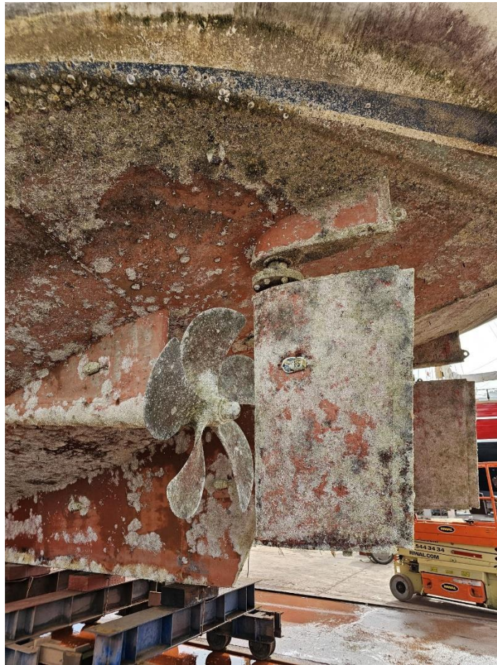
Slika 12. Obraštanje broda u području propelera
