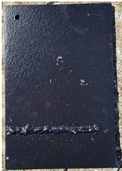
Slika 53. Uzorak I1 nakon nanošenja kompletnog sustava premaza
