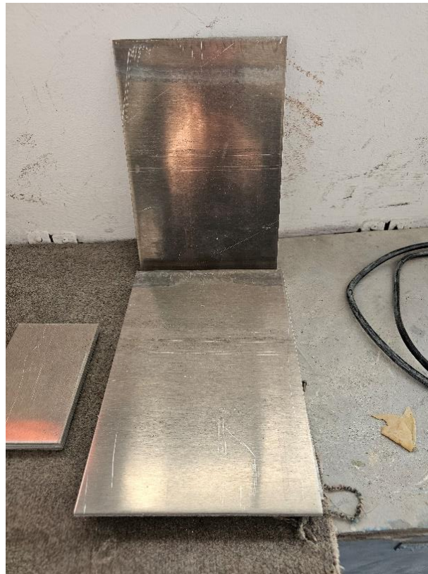
Slika 38. Aluminijski uzorci neposredno nakon rezanja, prije obrade površine
