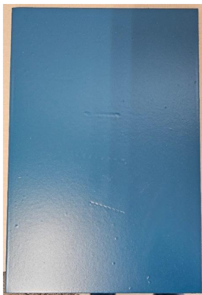
Slika 47. Uzorak J2 nakon nanošenja kompletnog sustava premaza
