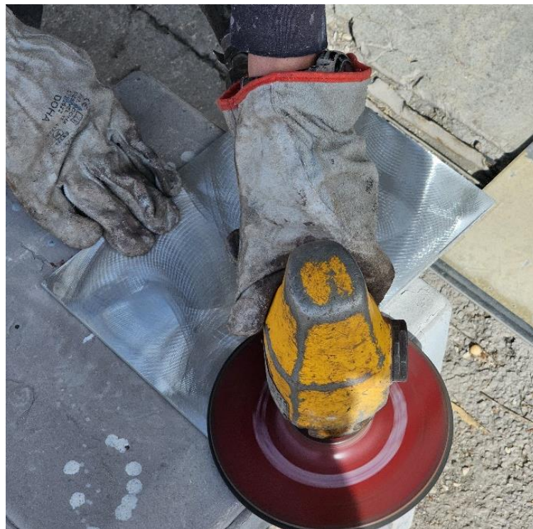
Slika 39. Obrada površine pneumatskom brusilicom
