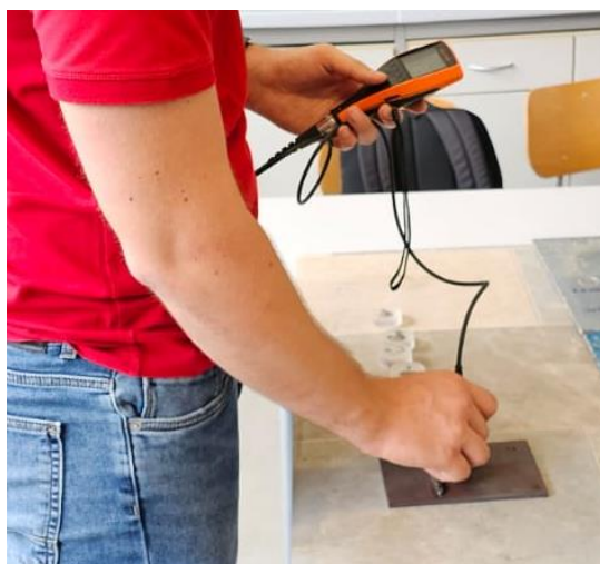
Slika 55. Postupak mjerenja debljine premaza
