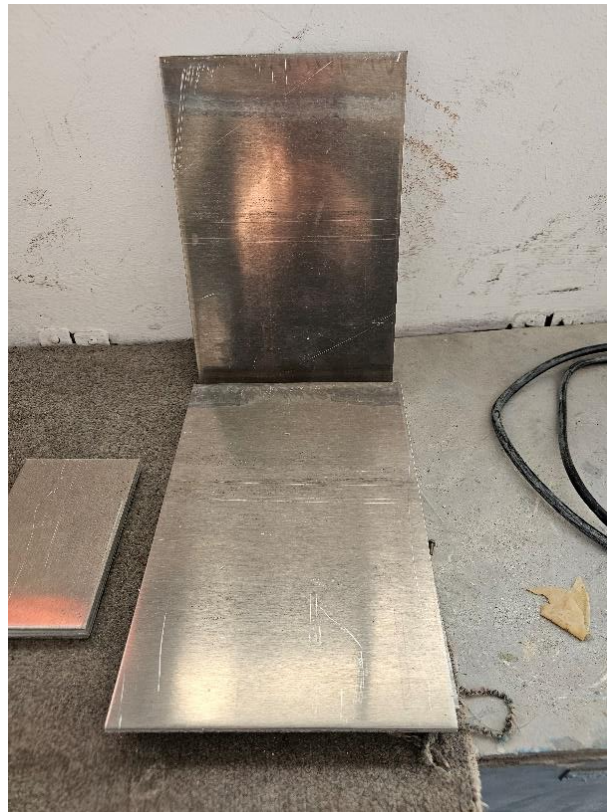
Slika 38. Alumijski uzorci neposredno nakon rezanja, prije obrade površine
