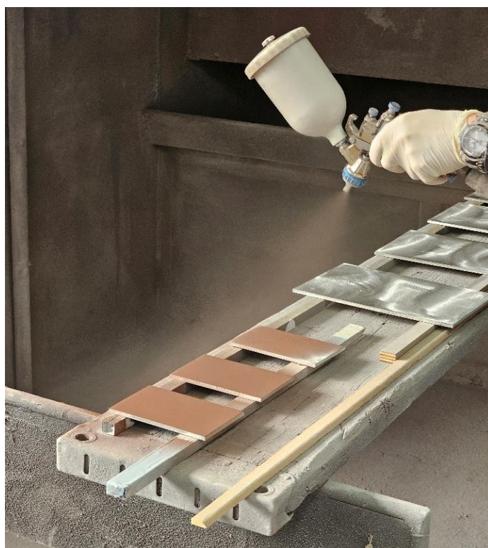
Slika 41. Nanošenje temeljnog premaza na uzorke u kabini za bojanje
