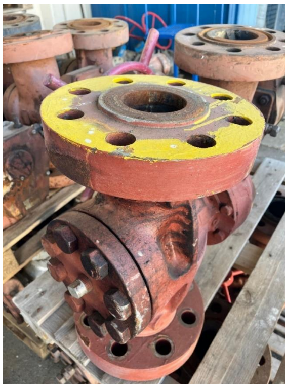
Slika 23. Ventili plinovoda pripremljeni za servis
