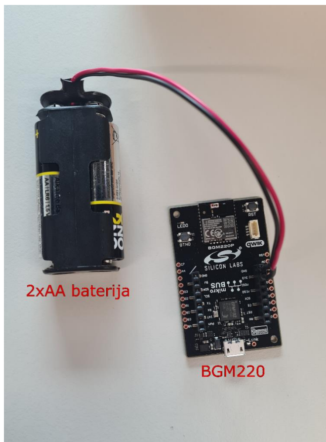
Slika 48. BGM220 napajan pomoću 2x AA baterije
