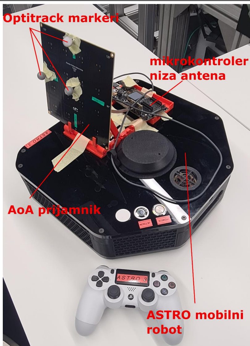
Slika 57. ASTRO robot s montiranim senzorom i Optitrack markerima
