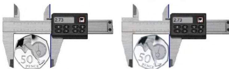
Slika 5. Mjerenje promjera na različitim mjestima [4]
