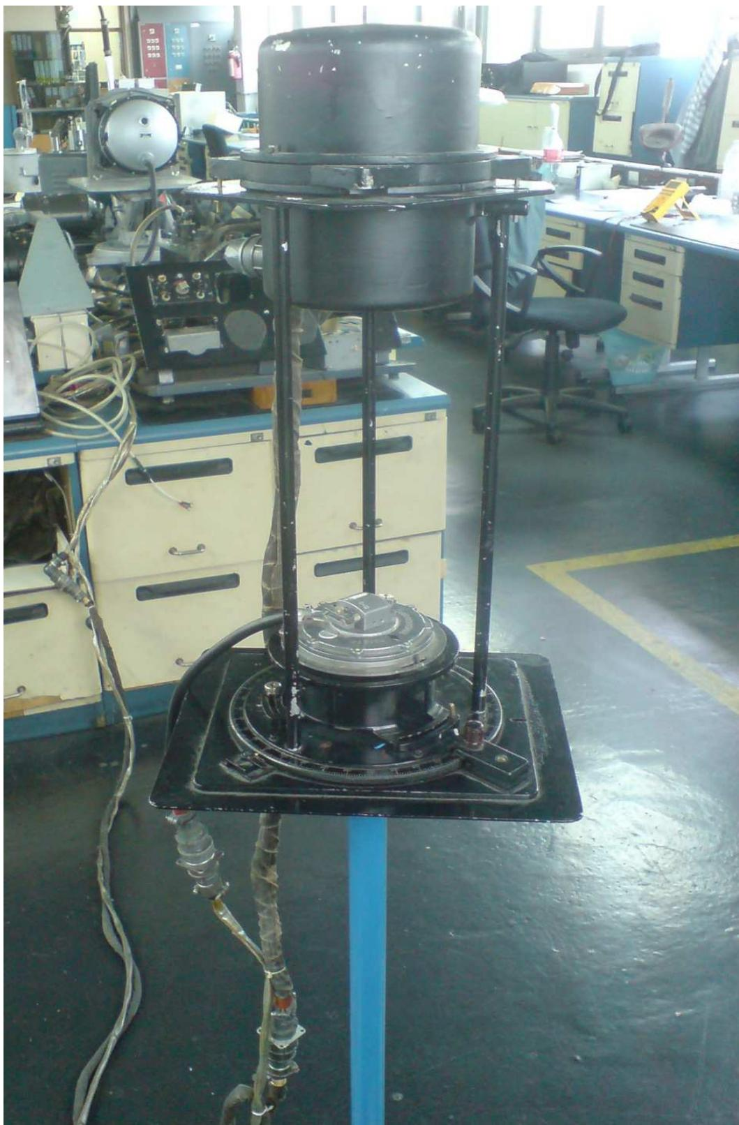
**Slika 3. Giromagnetski kompas GMK-1AE na ispitnom postolju u ZTC d.d.**
