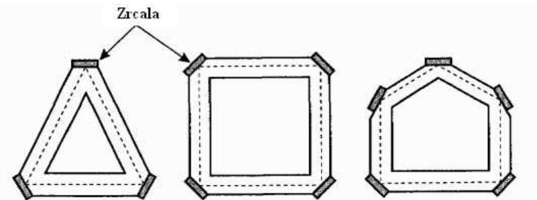
Slika 8. Izvedbe lasera s kružnim rezonatorom [6]
