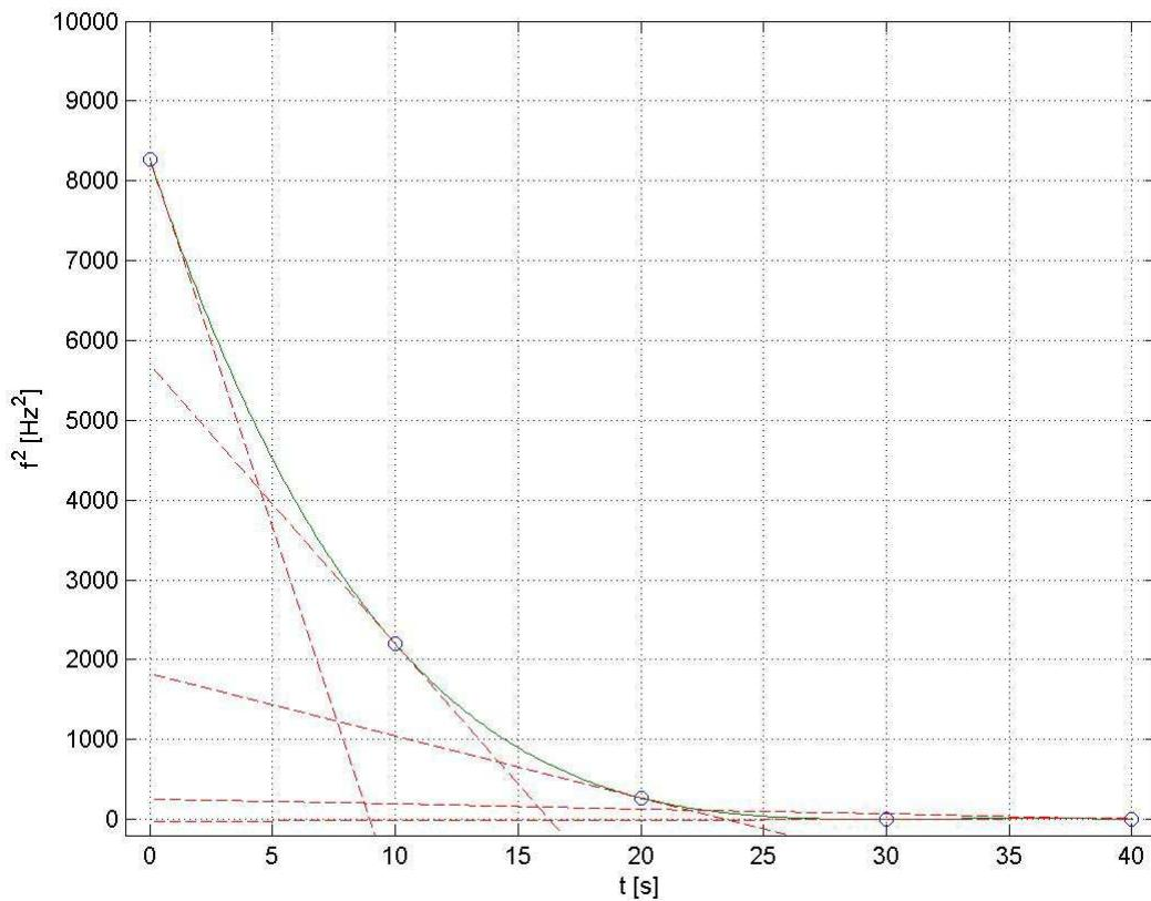
Slika 22. Pad energije sustava u vremenu i tangente u karakterističnim točkama za nagib  $+45^\circ$
