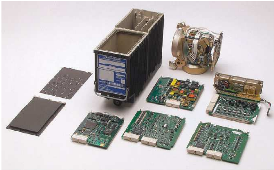
Slika 13. Sastavni dijelovi LTN-101E sustava [8]
