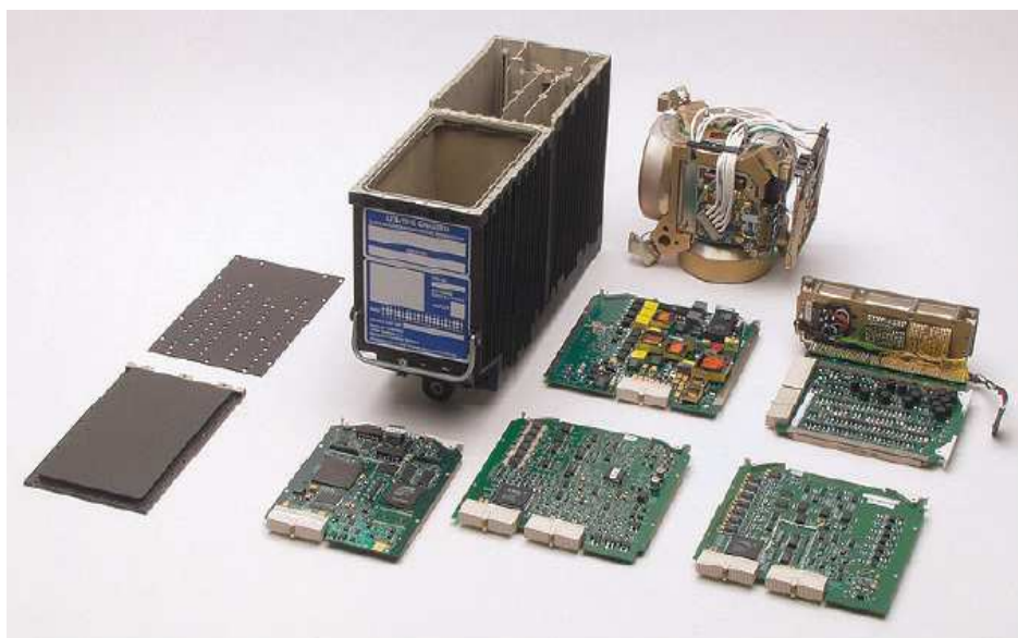
Slika 13. Sastavni dijelovi LTN-101E sustava [8]
