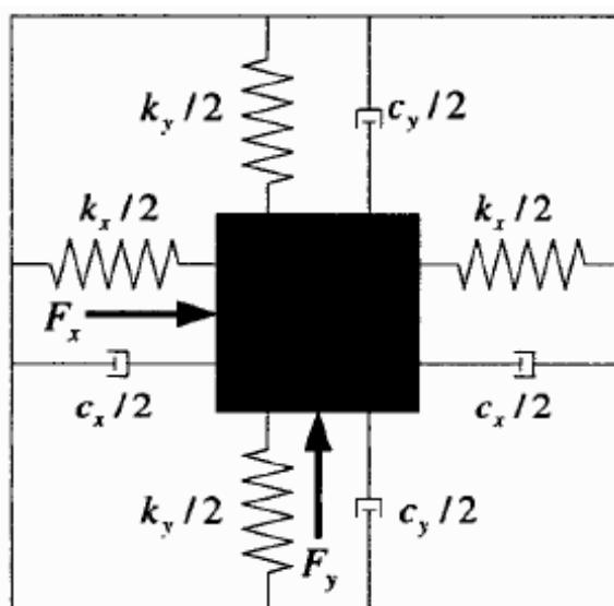
Slika 14. Shematski prikaz vibracijskog MEMS giroskopa [9]
