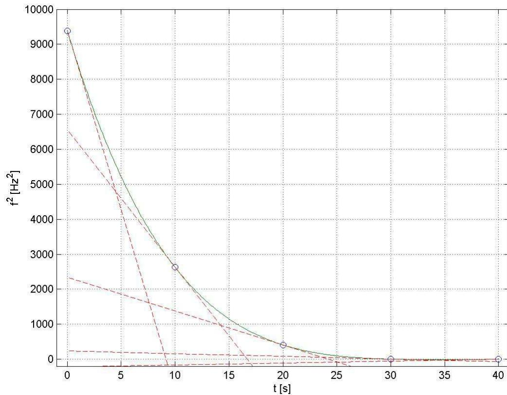
Slika 20. Pad energije sustava u vremenu i tangente u karakterističnim točkama za nagib  $0^\circ$
