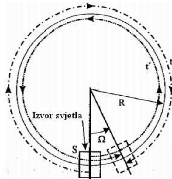
Slika 5. Kružni interferometar [6]
