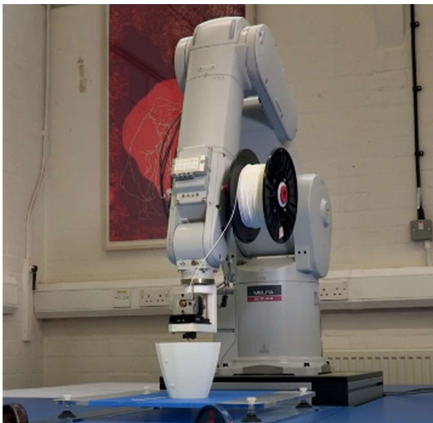
Slika 12. Robotska ruka kod 3D ispisa [12]
