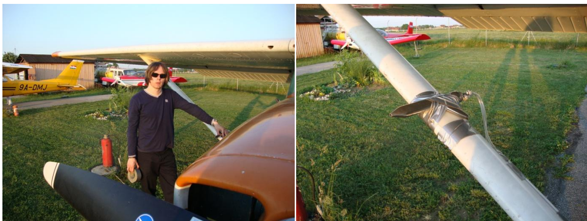
Slika 7.1 a) Montaža Pitot cijevi na desnu upornicu b) Montirana Pitot cijevi na desnu upornicu
