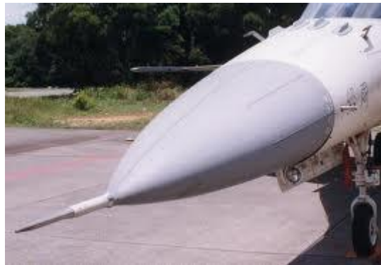
Slika 6.2 Pitot cijevi zrakoplova F-16 [21]
