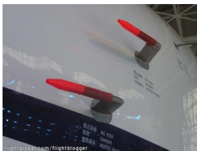
Slika 2.5 Pitot cijevi, modernog transportnog zrakoplova [22]
