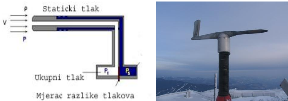
Slika 2.1 a) Shema Pitot-statičkog sustava [1] b) Primjer Pitot cijevi korištene za meteorološka mjerenja [24]
