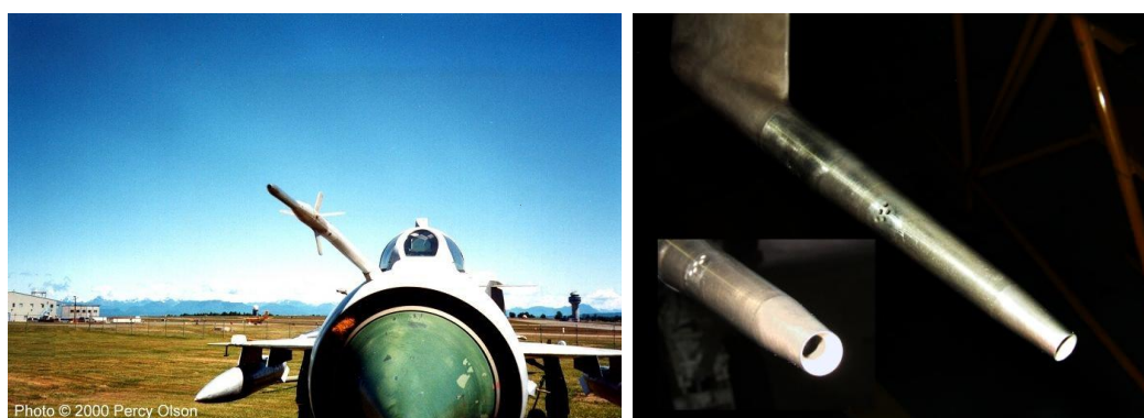
Slika 2.8 a) Air data probe zrakoplova Mig-21 [15] b) Pitot-statička cijev zrakoplova F/A-18 [18]
