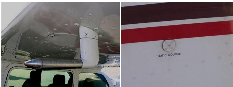
Slika 2.6 a) Pitot cijevi zrakoplova Cessna-172 b) Sonda za statički tlak, zrakoplova Cessna-172 [15]
