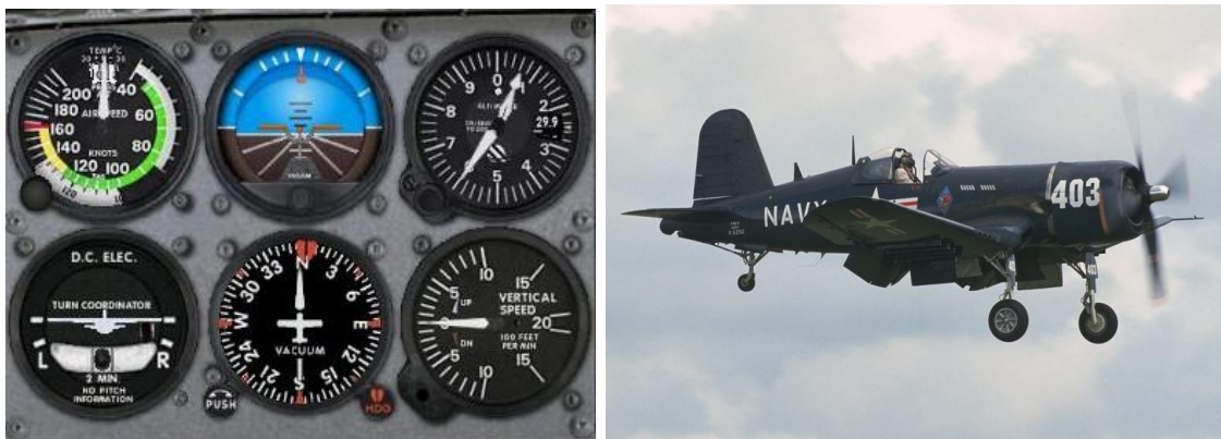
Slika 1.2 a) Osnovnih šest instrumenata za upravljanje zrakoplovom [16] b) Avion Corsair F6-U s Kollsmanovom Pitot cijevi na vrhu lijevog polukrila [17]
