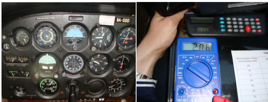
Slika 7.8 a) Instrumentalna ploča zrakoplova u polijetanju b) Iznos napona dobiven tijekom mjerenja, odgovara brzini 55 kt
