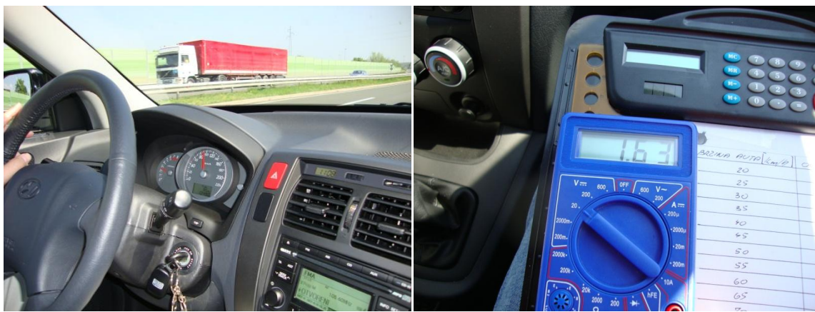
Slika 6.3 a) Brzina od 95 km/h očitana na brzinomjeru automobila b) Iznos napona dobiven tijekom mjerenja, odgovara brzini 95 km/h
