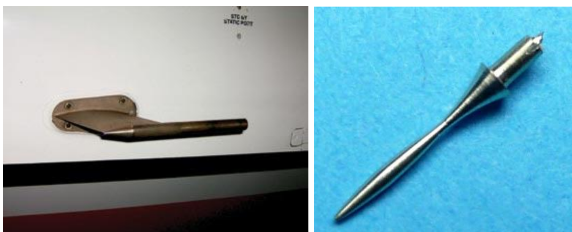
Slika 2.7 a) Pitot cijev za visoko podzvučni zrakoplov [25] b) Pitot cijev za zrakoplov Mirage 2000C [14]
