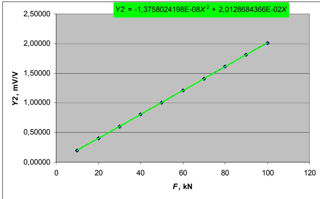
Slika 33: Prikaz rezultata umjeravanja etalona Z4/100 kN polinomom 2. stupnja:
