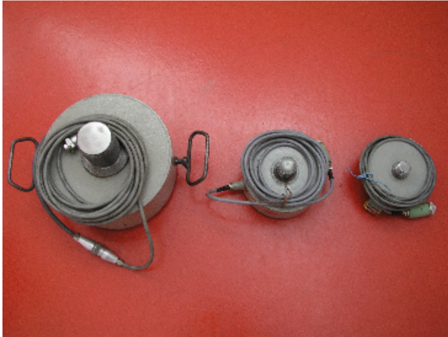
Slika 14: Dinamometri tipa Z4, slijeva na desno: Z4/500 kN, Z4/200 kN, Z4/100 kN
