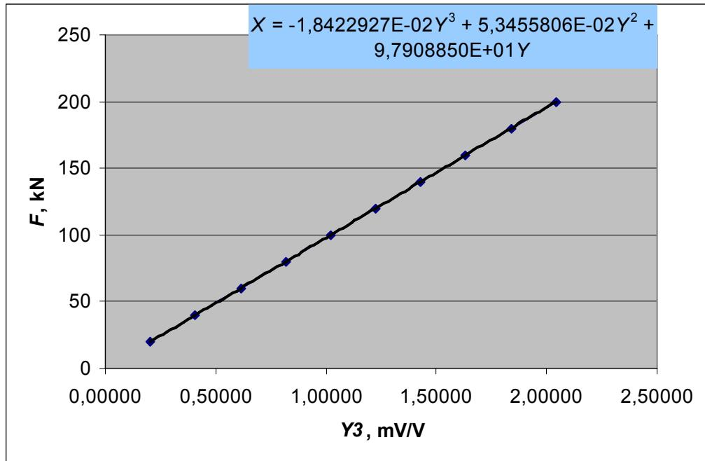
Slika 46: Inverzni prikaz rezultata umjeravanja etalona Z4/200 kN polinomom 3. stupnja:
