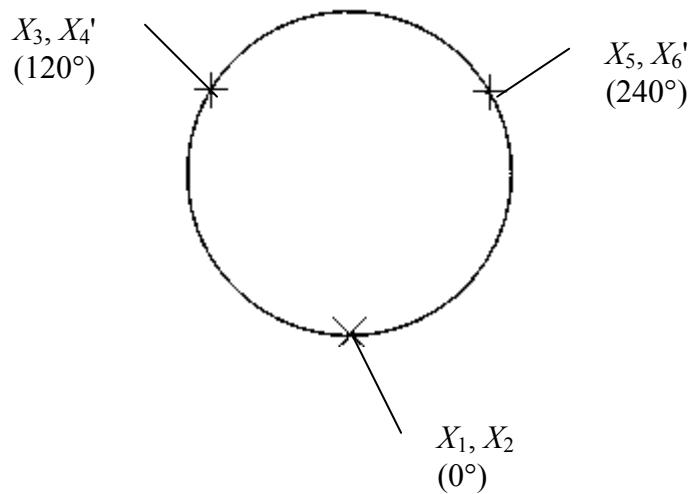
Slika 11: Pozicije mjernih nizova na dinamometru umjeravanog etalona [9]
