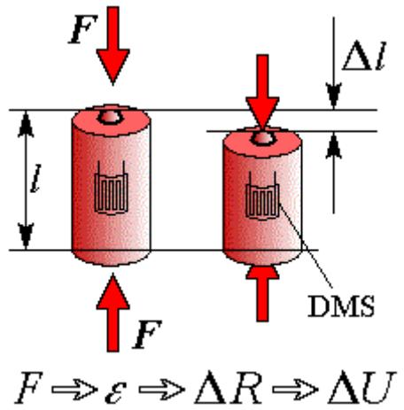
Slika 7: Primjer indirektnog mjerenja sile pomoću DMS traka [7]
