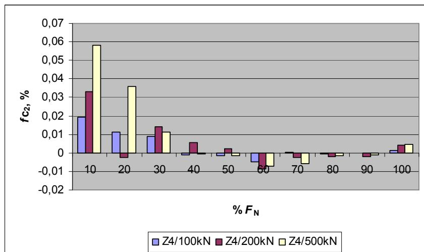
Slika 29: Usporedba relativnog interpolacijskog odstupanja za polinom 2. stupnja
