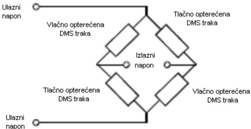
Slika 8: Položaj DMS mjernih traka u Wheatstonovom mostu [1]
