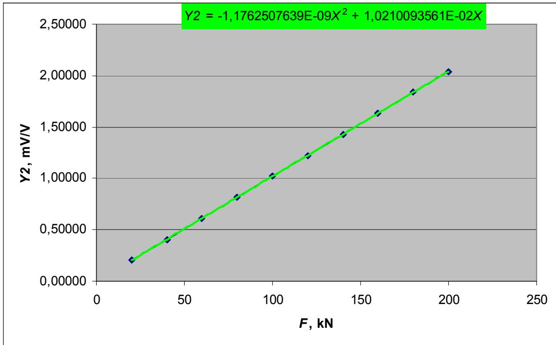
Slika 42: Prikaz rezultata umjeravanja etalona Z4/200 kN polinomom 2. stupnja:
