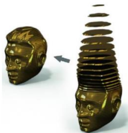
Slika 6. Ispis modela glave sloj po sloj [10]
