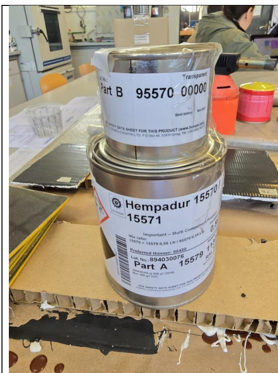
Slika 20 Komponente Hempel temelja
