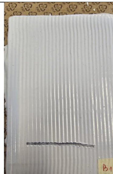
Slika 52 Uzorak B1 prije slane komore
