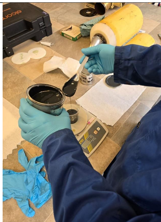
Slika 32 Mješanje Helios završnog premaza
