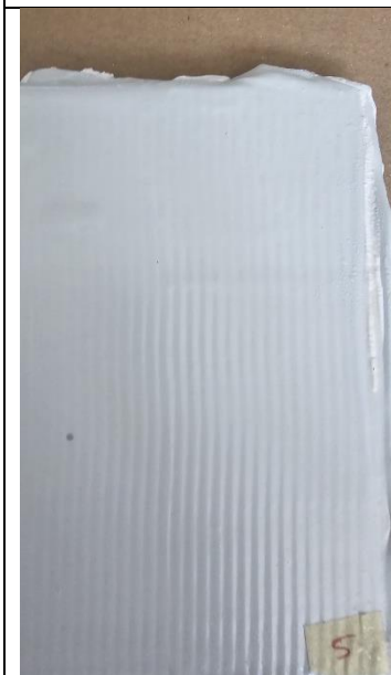
Slika 64 Pločica 5 nakon vlažne komore
