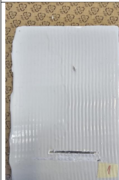
Slika 50 Uzorak 1 prije slane komore
