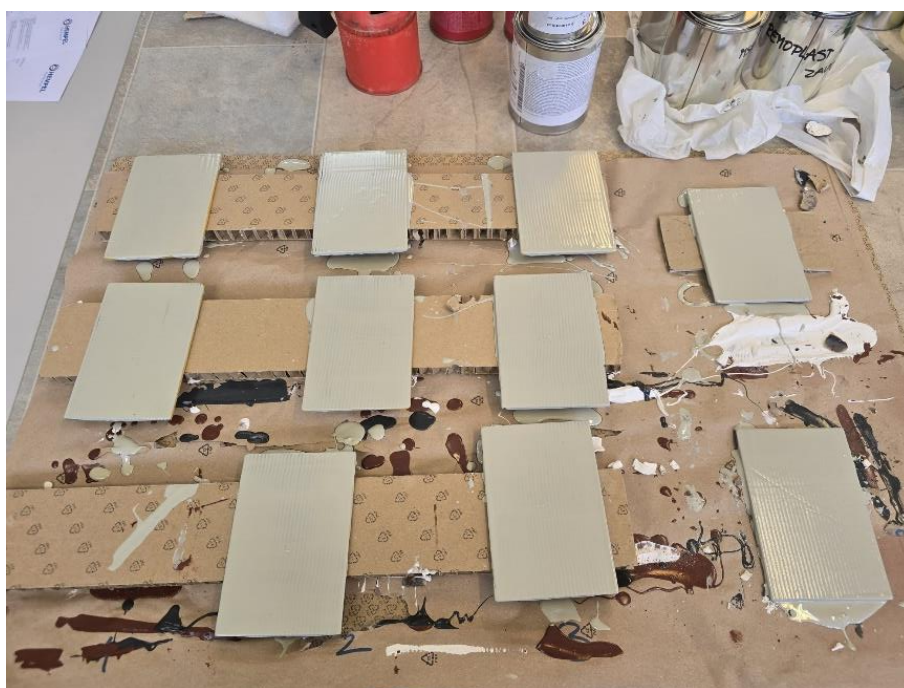
Slika 25 Sušenje Hempel temeljnog premaza
