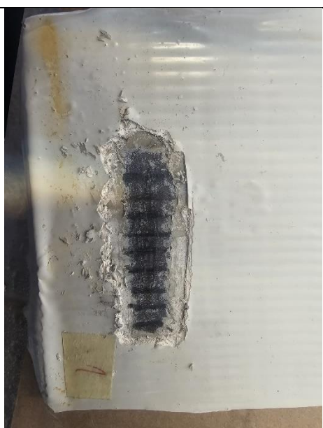
Slika 55 Pločica I nakon slane komore
