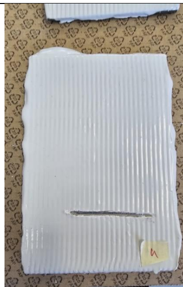
Slika 51 Uzorak 4 prije slane komore
