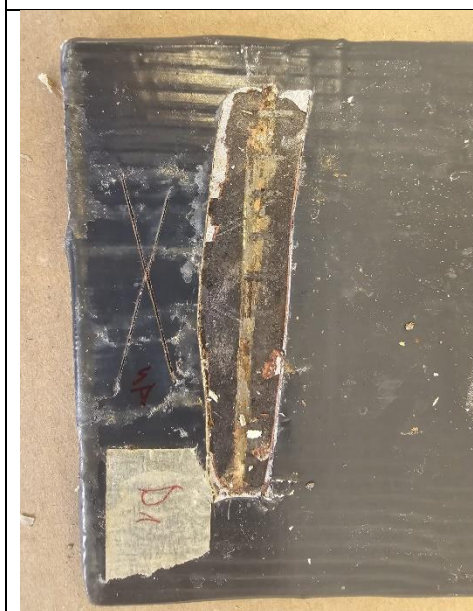
Slika 56 Pločica D1 nakon slane komore
