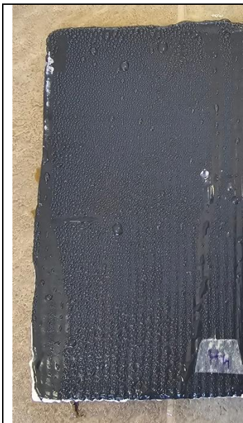
Slika 61 Pločica H4 nakon vlažne komore
