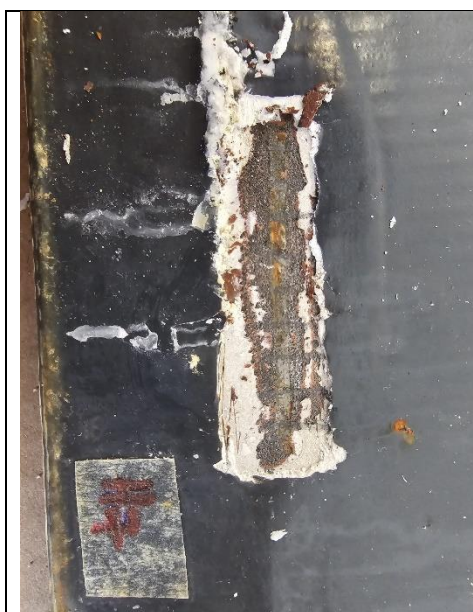
Slika 54 Pločica H7 nakon slane komore
