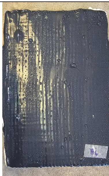
Slika 62 Pločica H6 nakon vlažne komore
