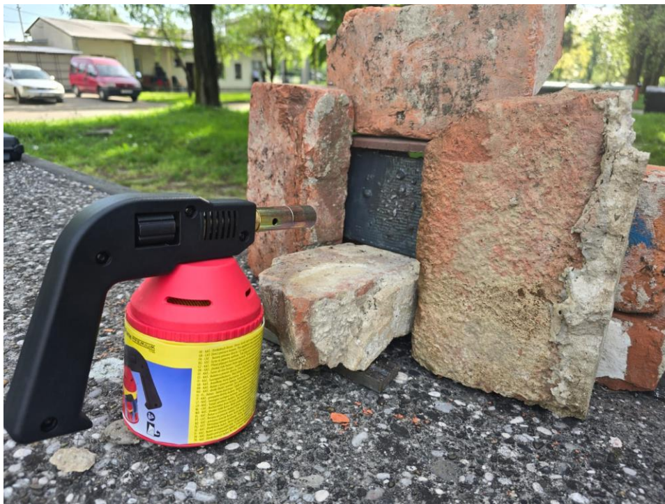
Slika 86 Ručni plamenik i ispitna zona
