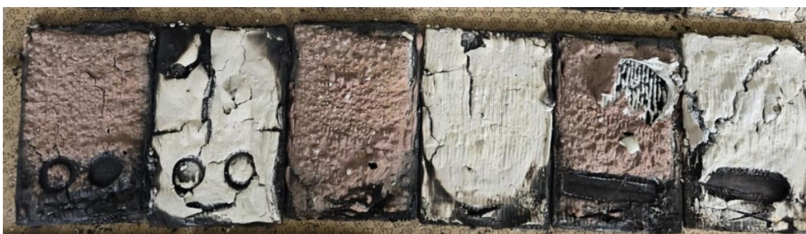
Slika 94 Pločice D1;D2;D3 i B1;B2;B3 nakon paljenja
