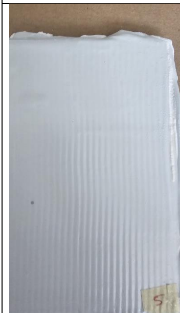
Slika 64 Pločica 5 nakon vlažne komore
