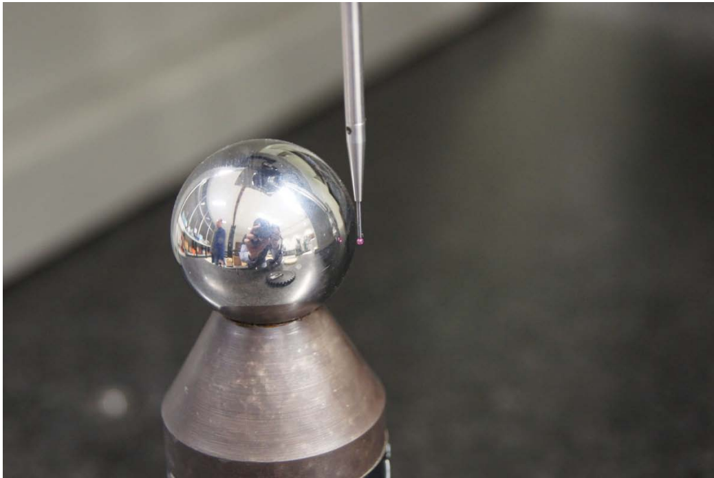
Slika 42. Etalon za umjeravanje ticala
