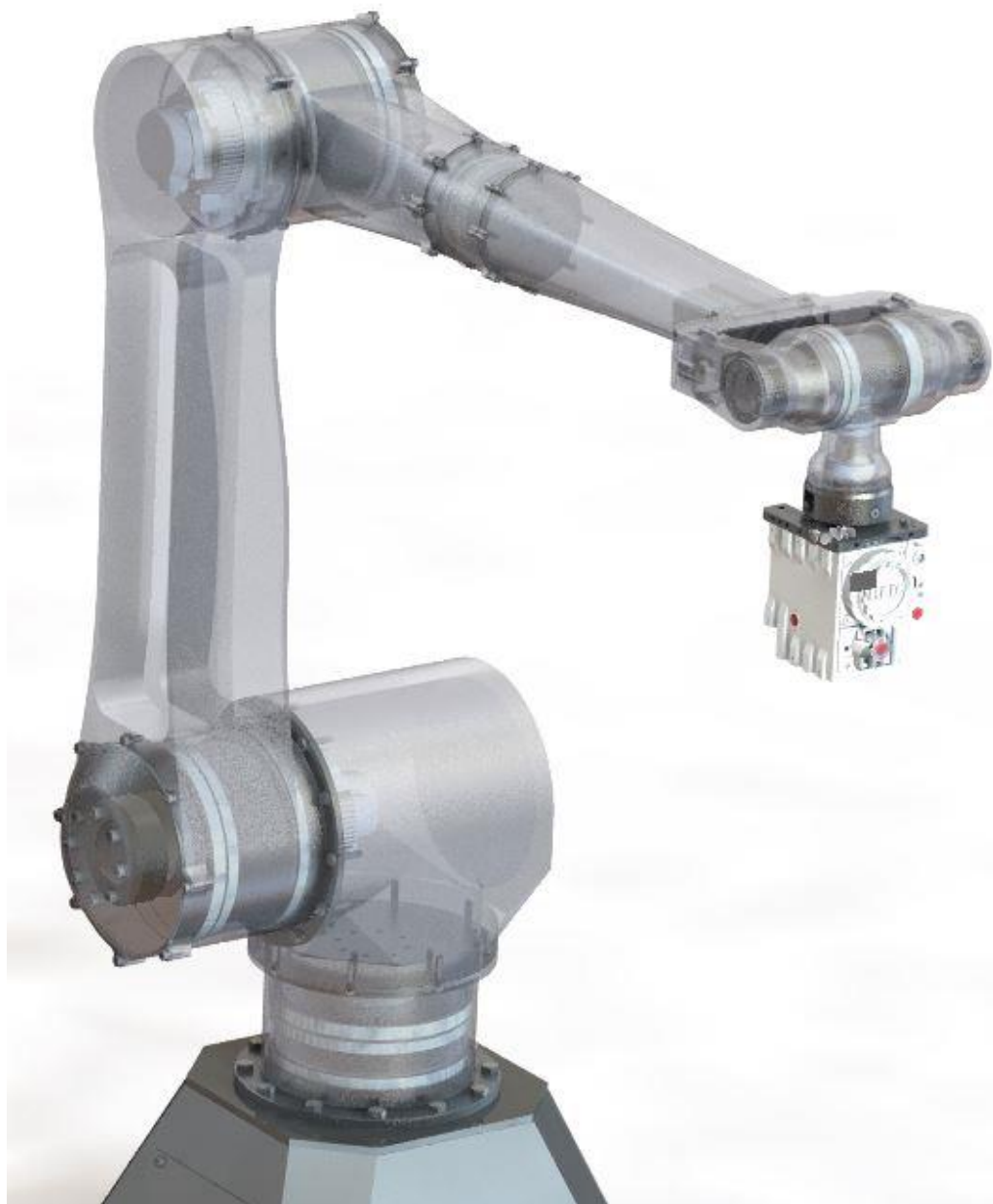
Slika 88. Robotska ruka s prikazanim pogonima u zglobovima
