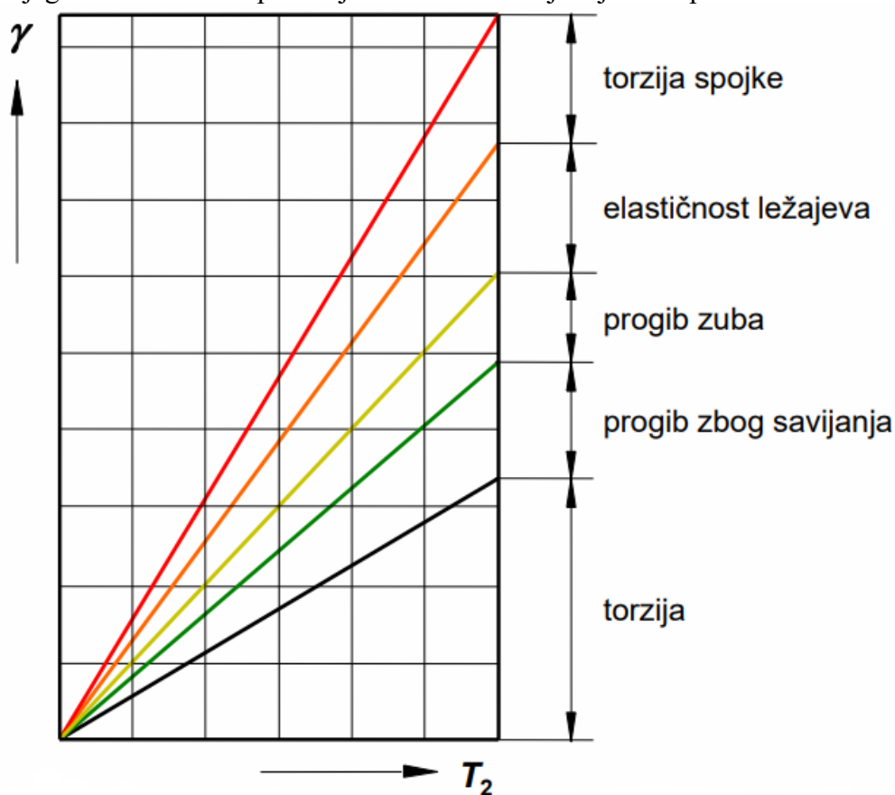
Slika 28. Utjecaj pojedinih deformacija elemenata prijenosnika na kutni pomak [18]
