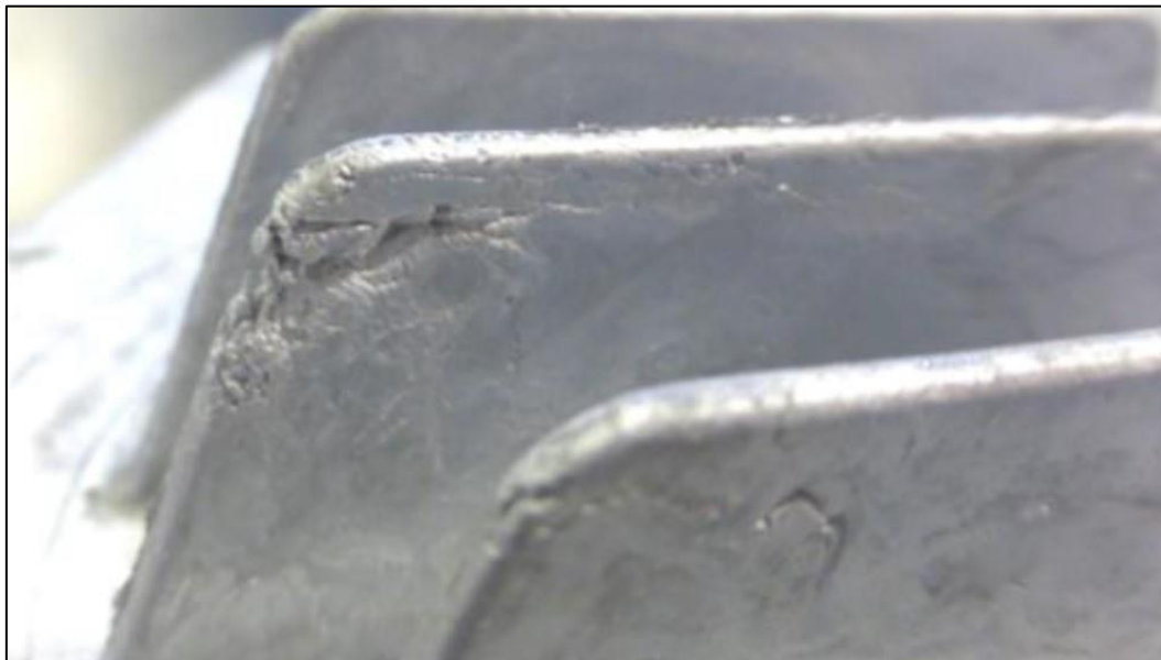
Slika 25 Nedolivenost na odljevku
