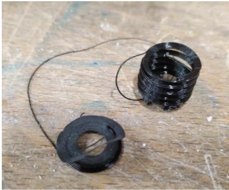
Slika 56 Prva konfiguracija glavne opruge
