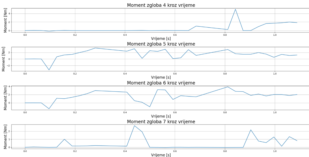
Slika 7.7. Momenti koljena robota (programiran hod)
