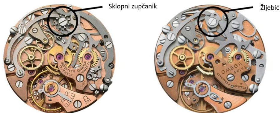
Slika 34. Mehanizam sa sklopnim zupčanikom i žljebićem [21]
