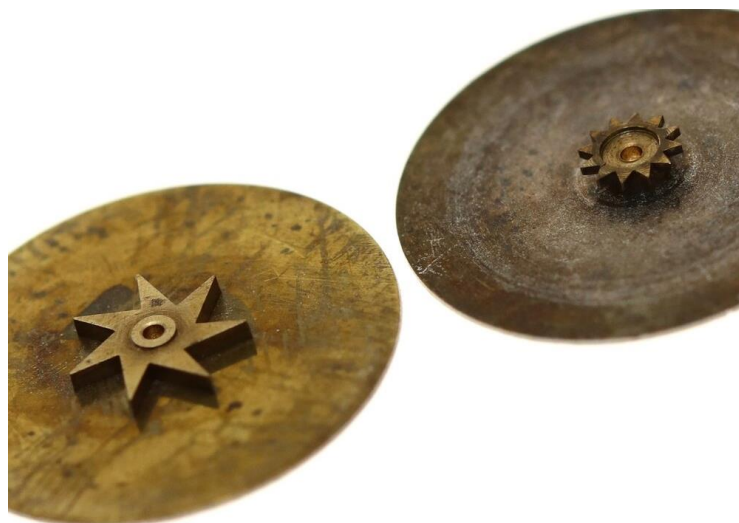
Slika 30. Zvijezde od 7 zubi i od 12 zubi [18]
