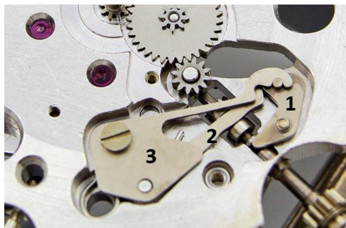
Slika 20. Mehanizam namještanja kazaljki [16]
