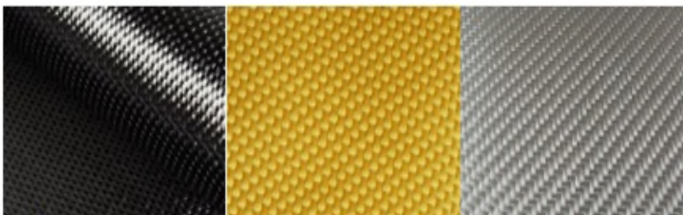
Slika 5. Ugljična, aramidna i staklena vlakna [7]
