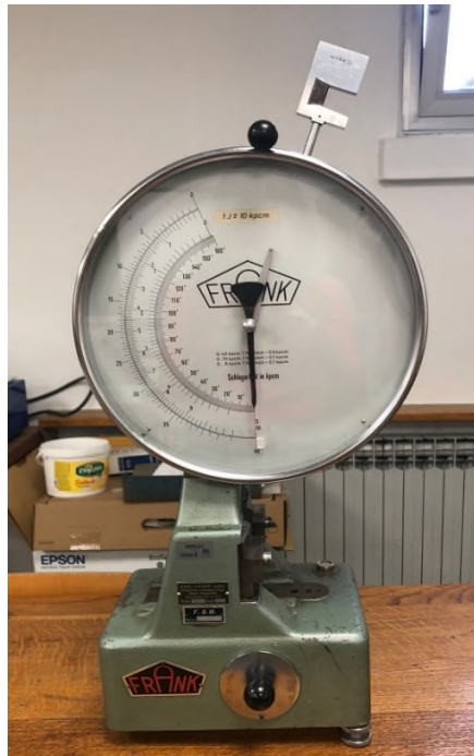
Slika 40. Charpy-jev bat za ispitivanje udarnog rada loma
