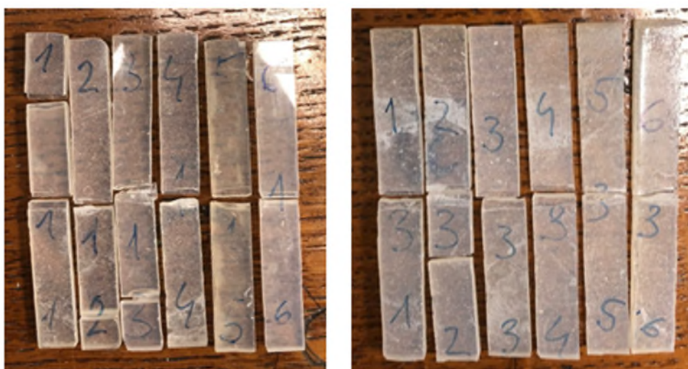
Slika 34. Ispitni uzorci s metalnim nanočesticama SiO 2 – 1 wt% (lijevo) i 2 wt% (desno) nakon provedenog savojnog ispitivanja
