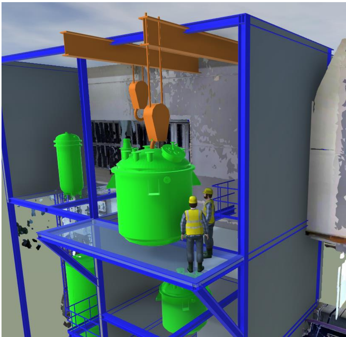
Slika 65. Pričvršćivanje reaktora na stropnu dizalicu
