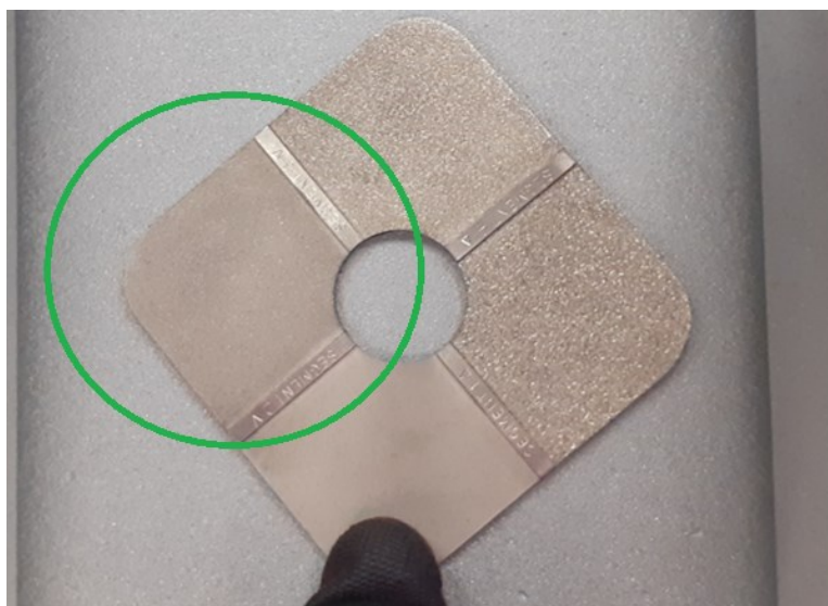
Slika 45. Komparator za kontrolu profila hrapavosti
