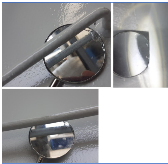
Slika 51. Nezatvoren film na nepristupačnim mjestima
