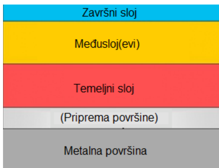
Slika 28. Shematski prikaz sustava premaza[30]
