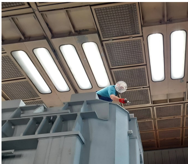
Slika 35. Ispuhivanje zaostale sačme komprimiranim zrakom
