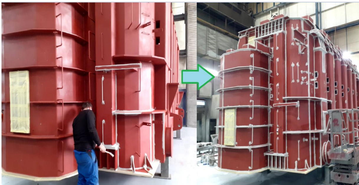
Slika 37. Nanošenje međusloja na teško dostupna
