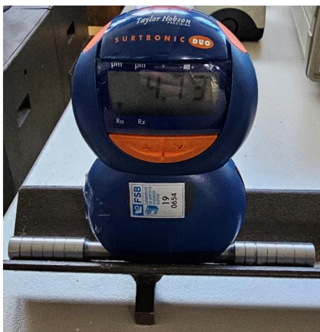
Slika 15. Mjerenje hrapavosti površine
