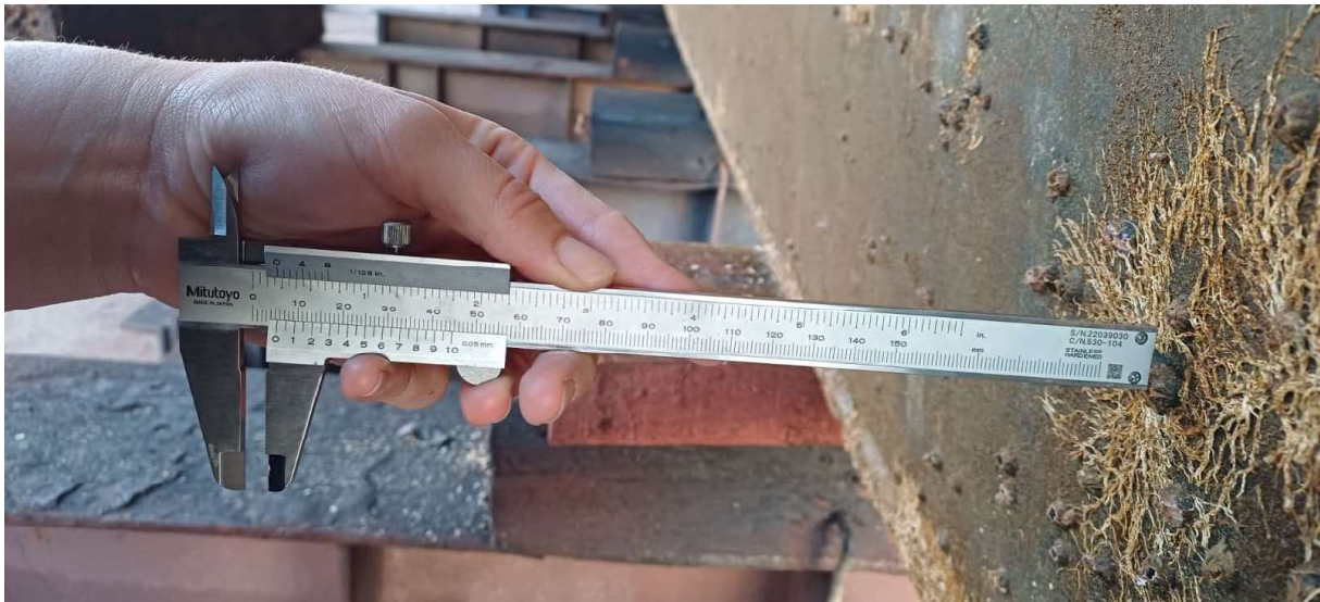
Slika 31. Primjer načina mjerenja u naravi
