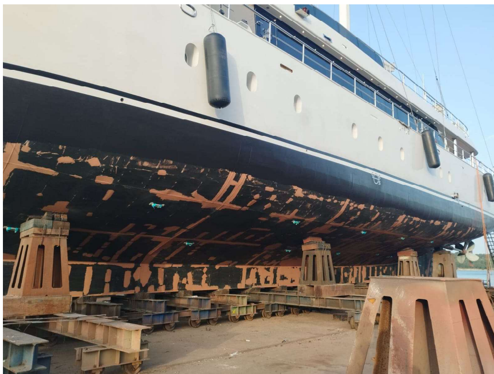
Slika 23. Lokalno nanesen međupremaz
