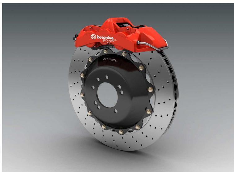
Slika 3.20. Primjer metalnog matričnog kompozita s česticama – dio kočionog sustava automobila [16]
