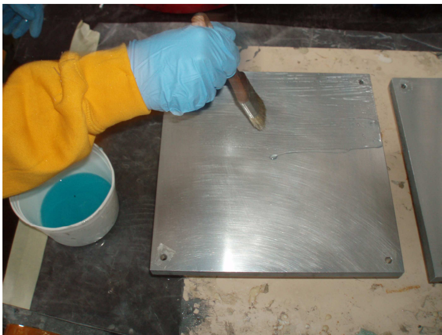
Slika 5.7. Nanošenje dvokomponentne epoksidne smole kistom na kalupne ploče
