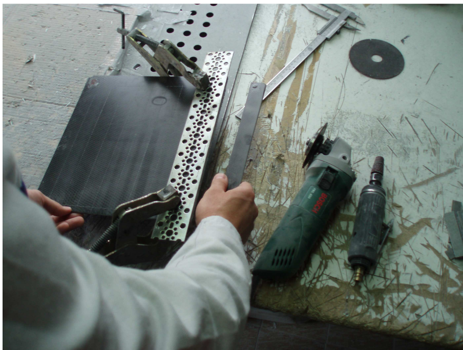
Slika 5.18. Izrezivanje ispitnih tijela iz kompozitnih ploča
