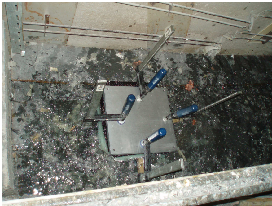
Slika 5.13. Polaganje kompozitne ploče s kalupom u peć
