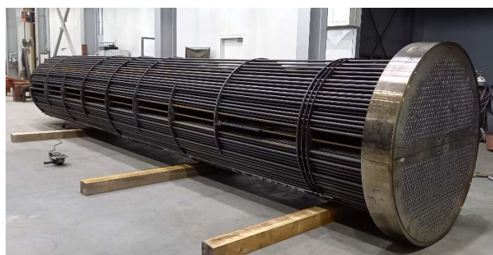
Slika 2. U-cijevni snop izmjenjivača topline (izvor: Pireko d.o.o)
