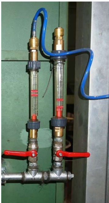
Slika 27. Pripremna i mjerna grupa uređaja za dovod zraka
