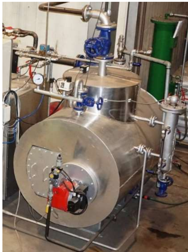
Slika 18. Izgled proizvedenog parnog kotla
