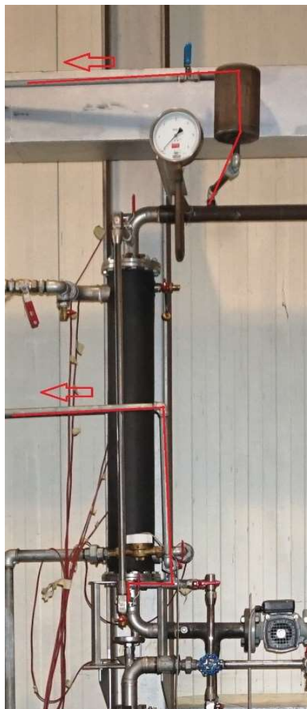
Slika 29. Odzračna mjesta na mjernoj liniji
