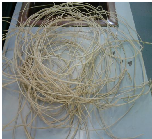
Slika 19. Poluproizvod nakon ekstrudiranja tzv. „špageti“
