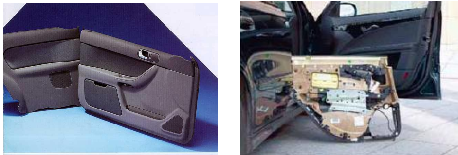
Slika 5. Primjena drveno polimernog kompozita u automobilskoj industriji [7]
