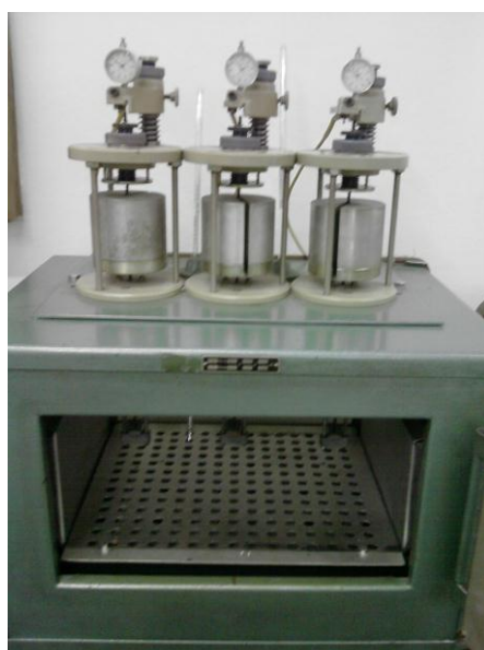
Slika 38. Uređaj za ispitivanje temperature omekšavanja
