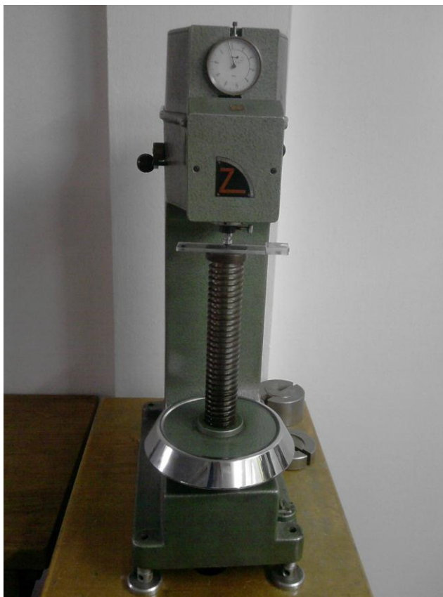
Slika 36. Uređaj za ispitivanje tvrdoće utiskivanjem kuglice Ø 5 mm
