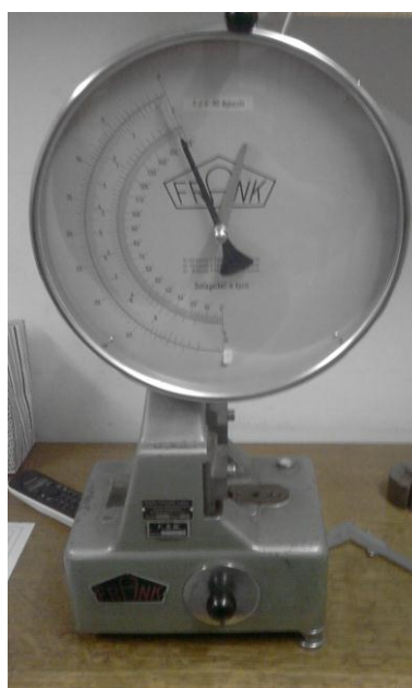
Slika 34. Uređaj za ispitivanje udarne radnje loma
