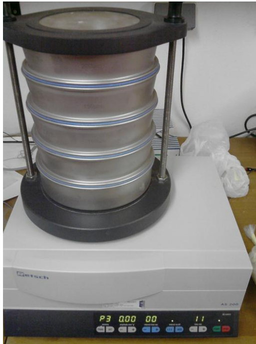
Slika 11. Uređaj za prosijavanje Retsch AS 200
