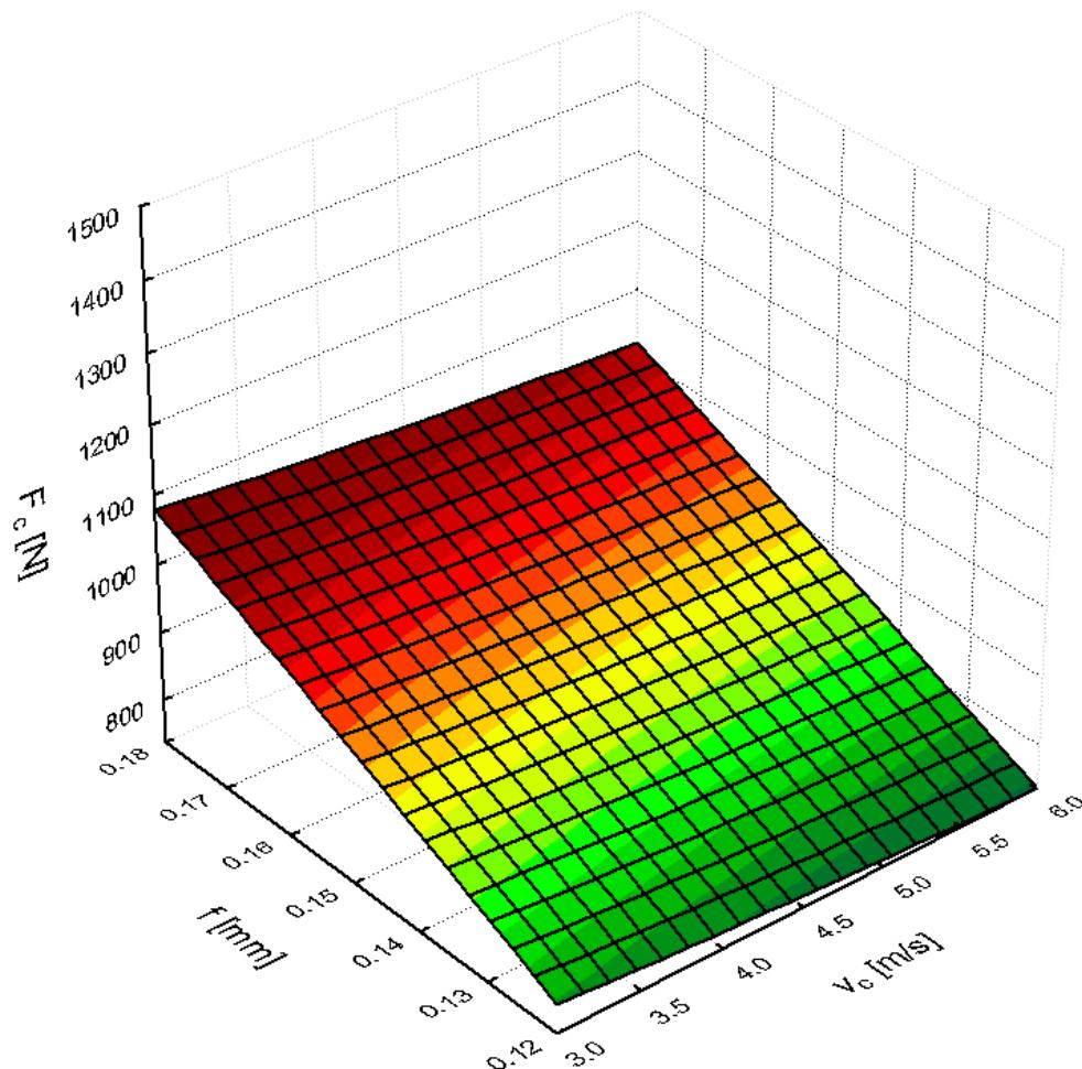
**Slika 22.** Dijagram ovisnosti  $F_c=f(v_c, f)$  za  $a_p=1,7 \text{ mm}$
