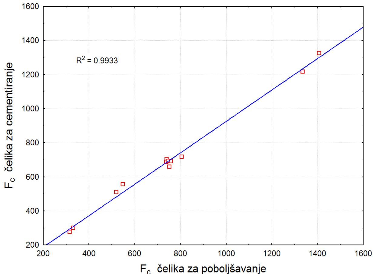
Slika 28. Usporedba eksperimentalnih vrijednosti za glavnu силу rezanja  $F_c$  dobivenu kod obrade čelika za cementiranje 16MnCr5 i čelika za poboljšavanje 34CrNiMo6
