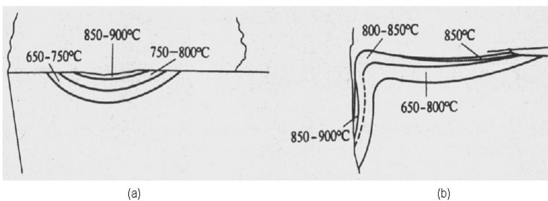
**Slika 16.** Presjek HSS alata korištenog kratko vrijeme pri ultra visokoj brzini (30 sek) kako bi se vidjele izoterme. (a) Željezo sa malim udjelom ugljika (152m/min). (b) CP nikal (53 m/min). Posmak 0.25 mm/okr. [10]
