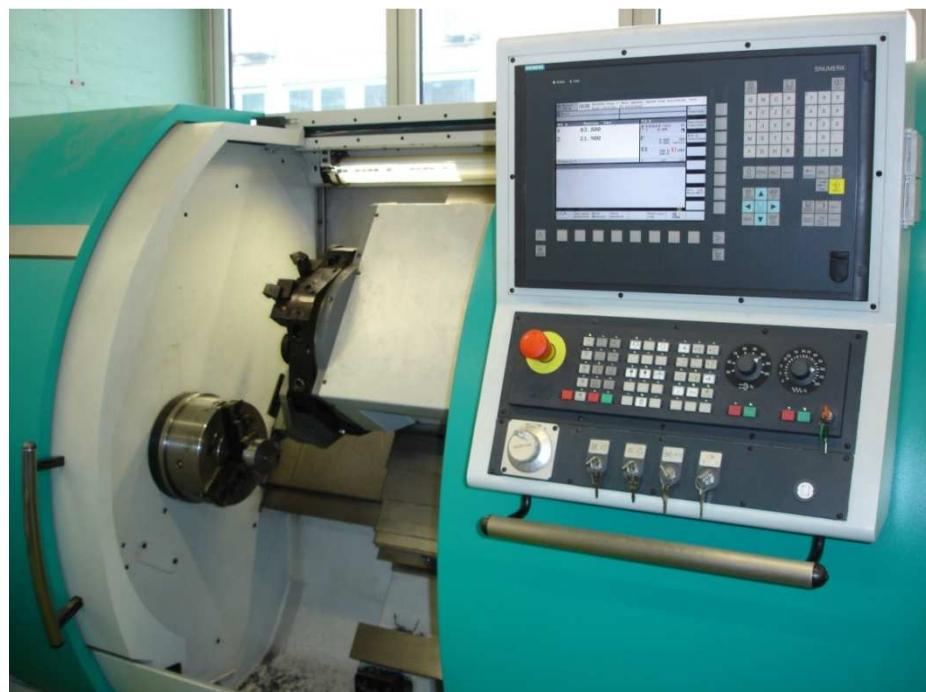
**Slika 18. Radni prostor tokarskog obradnog centra Trens SBL-500**
