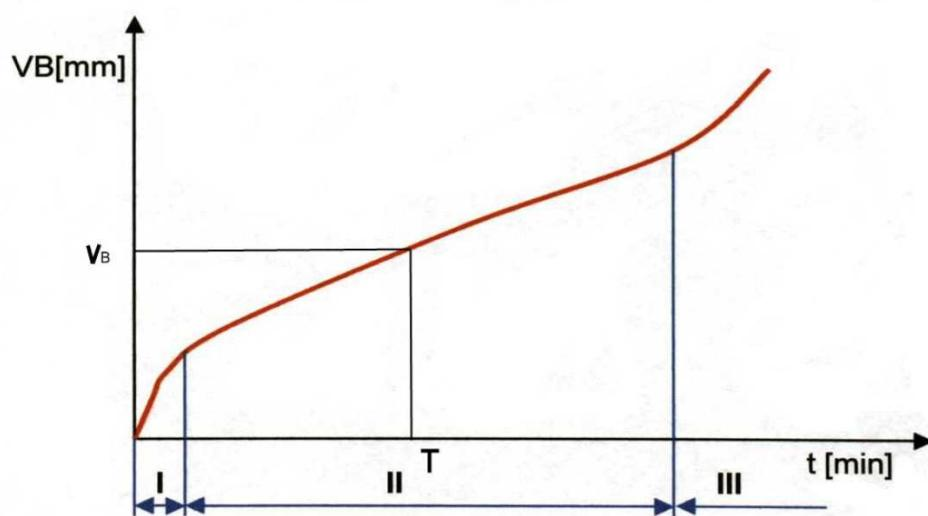
**Slika 3.** Tipska krivulja trošenja reznih alata [6]
