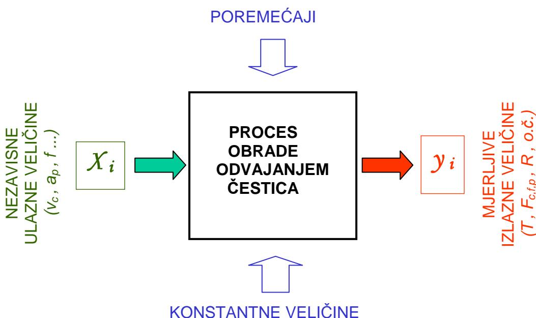
Slika 6. Shematski prikaz procesa obrade odvajanjem čestica [7]
