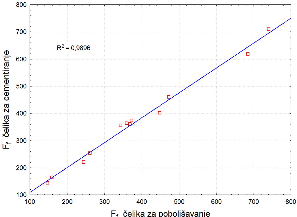
**Slika 29. Usporedba eksperimentalnih vrijednosti za posmičnu силу rezanja  $F_f$  dobivenu kod obrade čelika za cementiranje 16MnCr5 i čelika za poboljšavanje 34CrNiMo6**
