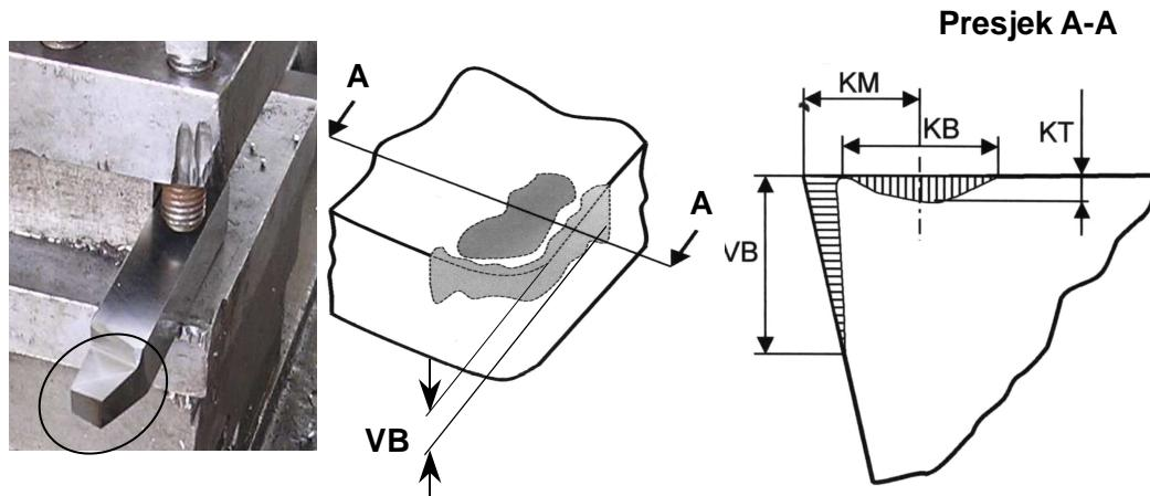
**Slika 2.** Parametri trošenja oštice reznog alata (VB – istrošenost stražnje površine alata, KM – udaljenost od središta kratera do teorijskog vrha oštice, KB – širina kratera, KT – dubina kratera) [6]
