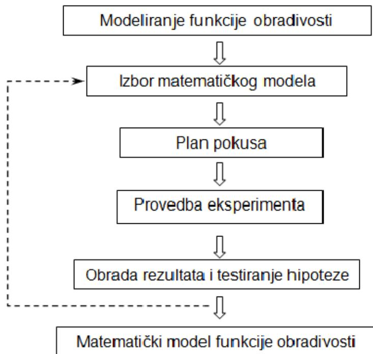
**Slika 7. Blok shema protokola eksperimentalnog istraživanja [8]**
