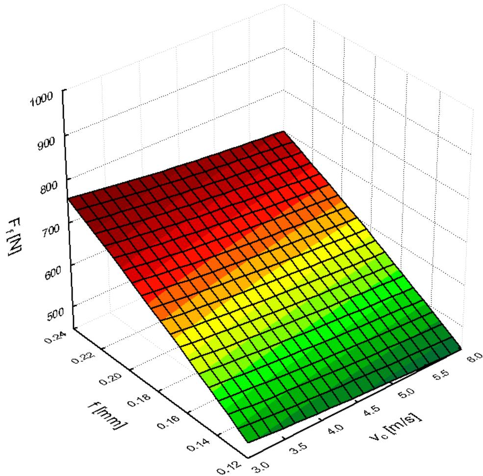
**Slika 25.** Dijagram ovisnosti  $F_f=f(v_c, f)$  za  $a_p=1,7 \text{ mm}$
