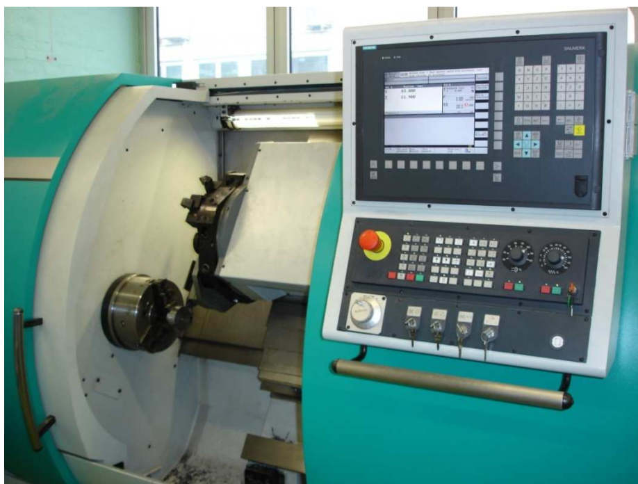
Slika 18. Radni prostor tokarskog obradnog centra Trens SBL-500
