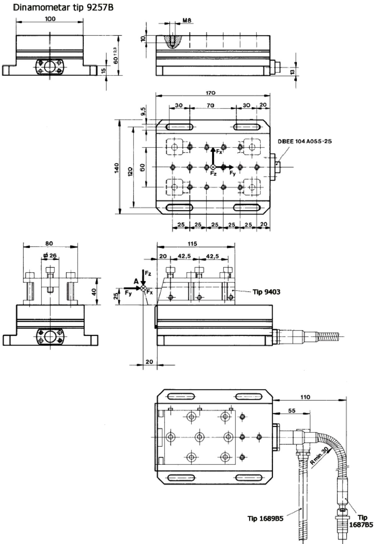
Slika 20. Prikaz uređaja za mjerjenje sila [17]
