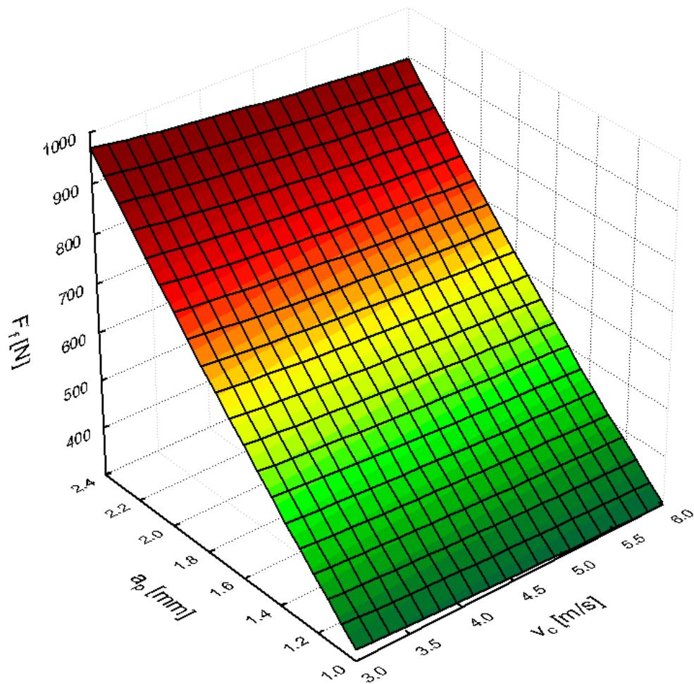
**Slika 24.** Dijagram ovisnosti  $F_f=f(v_c, a_p)$  za  $f_{sr}=0,18 \text{ mm}$
