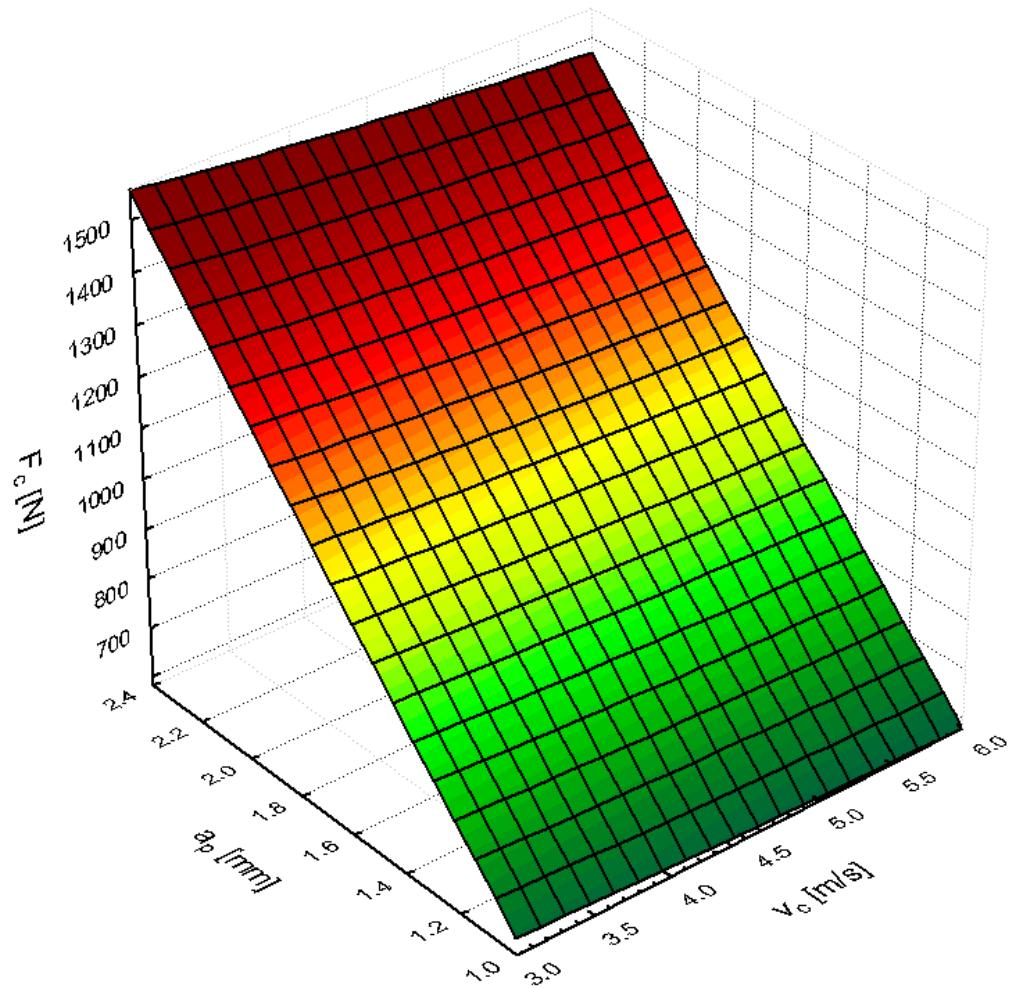
Slika 21. Dijagram ovisnosti  $F_c=f(v_c, a_p)$  za  $f_{sr}=0,18 \text{ mm}$
