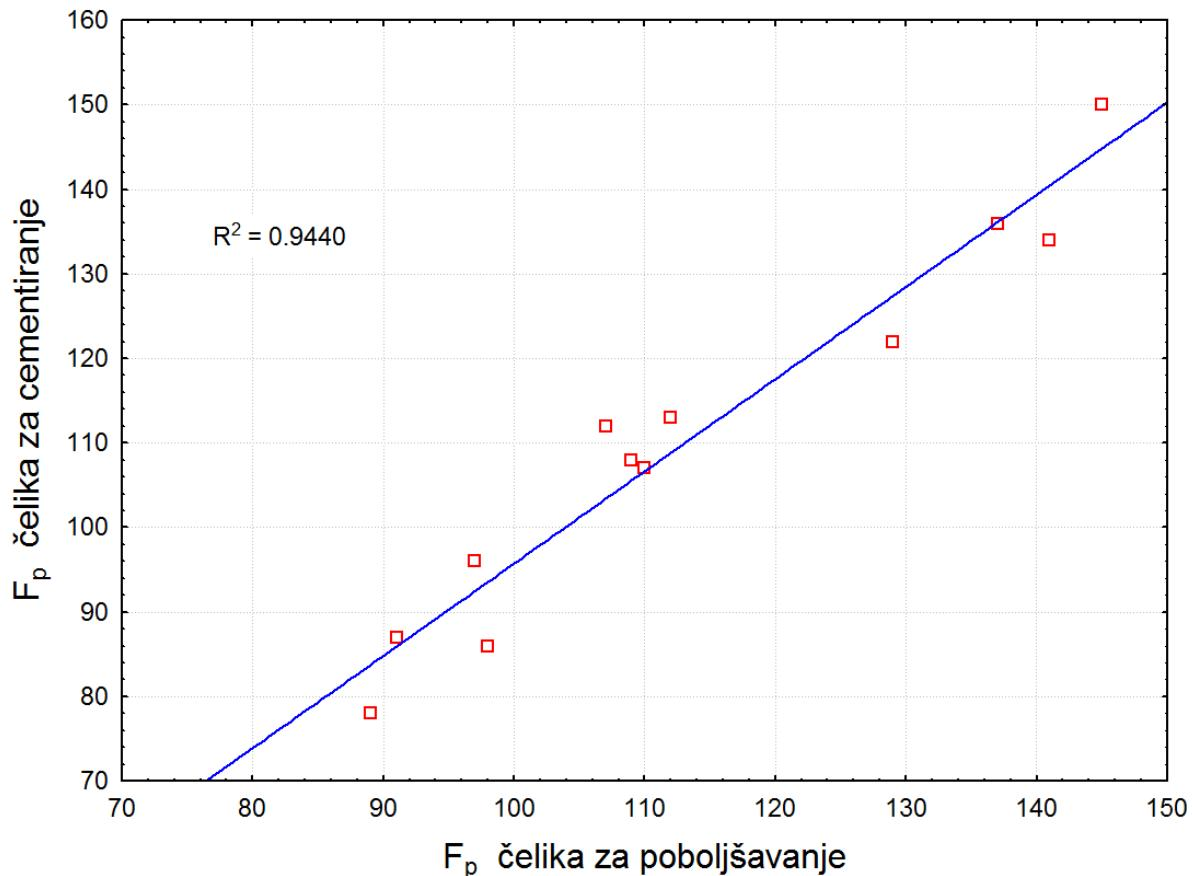
**Slika 30. Usporedba eksperimentalnih vrijednosti za natražnu силу rezanja  $F_p$  dobivenu kod obrade čelika za cementiranje 16MnCr5 i čelika za poboljšavanje 34CrNiMo6**
