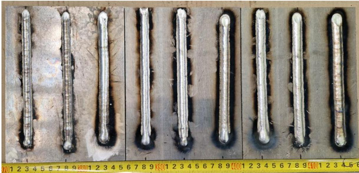
**Slika 37. Prikaz svih uzoraka nakon navarivanja**
