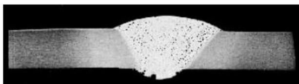
**Slika 5. Poroznost u TIG zavaru ploče debljine 6 mm [5]**
