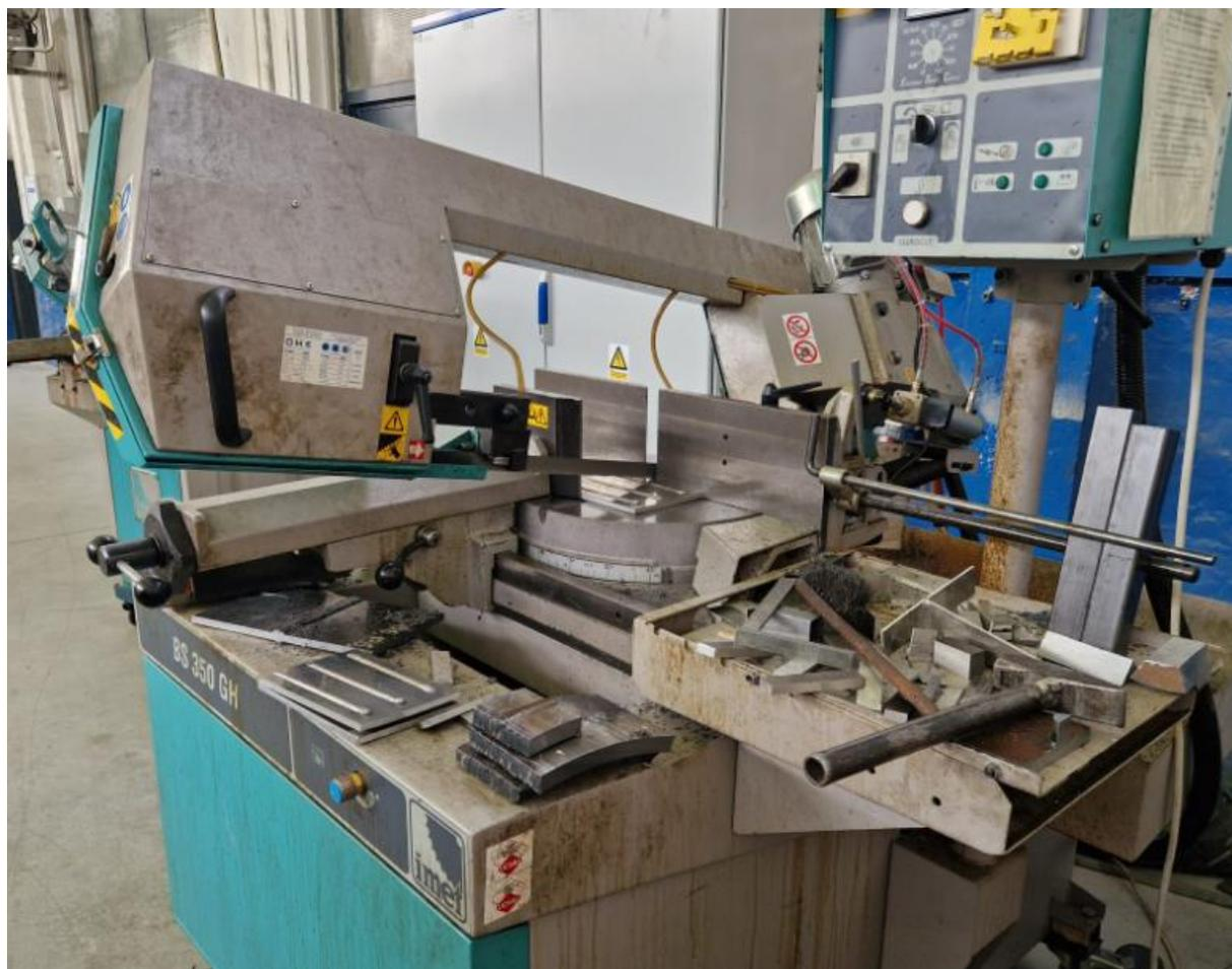
**Slika 48. Pila za rezanje uzoraka „BS 350 GH“**
