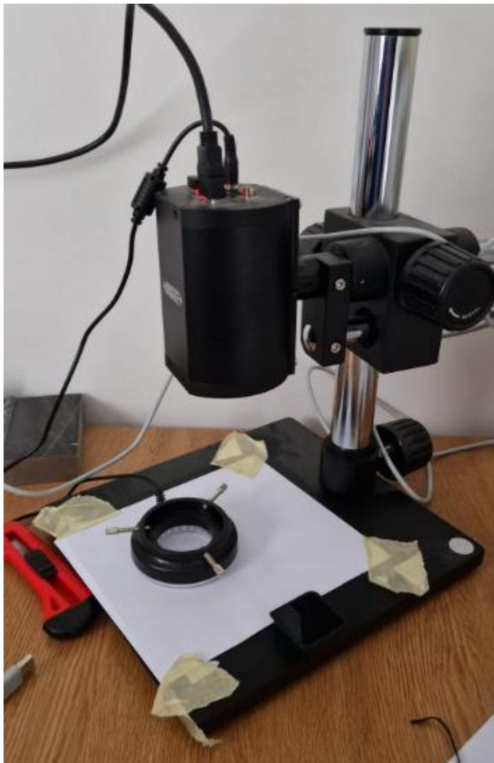
**Slika 49. Mikroskop „Insize“ za slikanje makrostrukture uzoraka**
