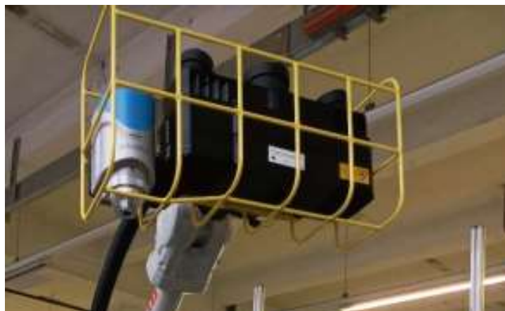
Slika 9. Zaštitna konstrukcija sa senzorima na prihvatnici robota
