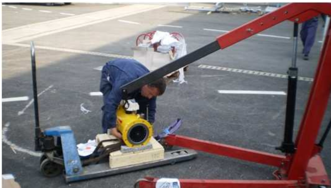
Slika 45. Priprema opreme za podizanje hidrauličnom dizalicom
