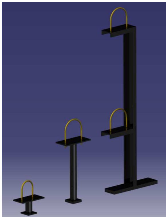
Slika 28. Elementi nosača cjevovoda
