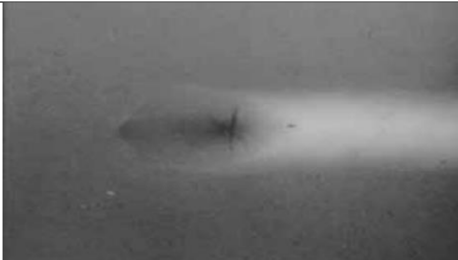
Slika 31. Radiografska snimka kraterske pukotine [8]
