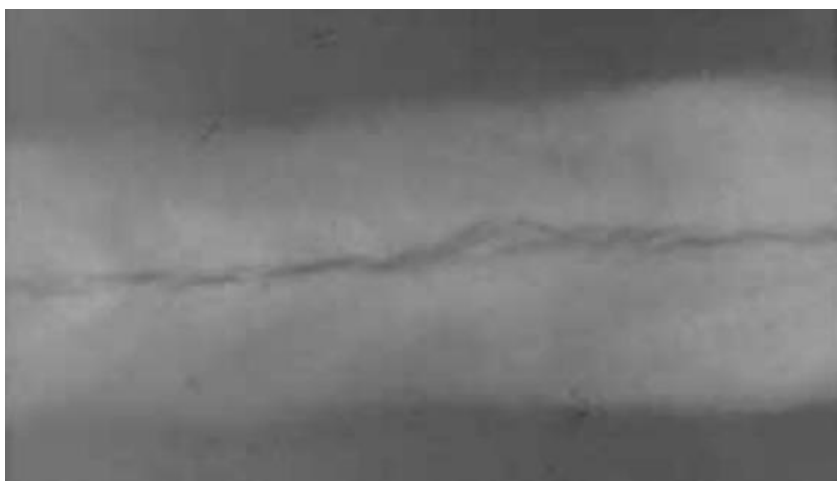
Slika 32. Radiografska snimka uzdužne pukotine zavara aluminija [8]
