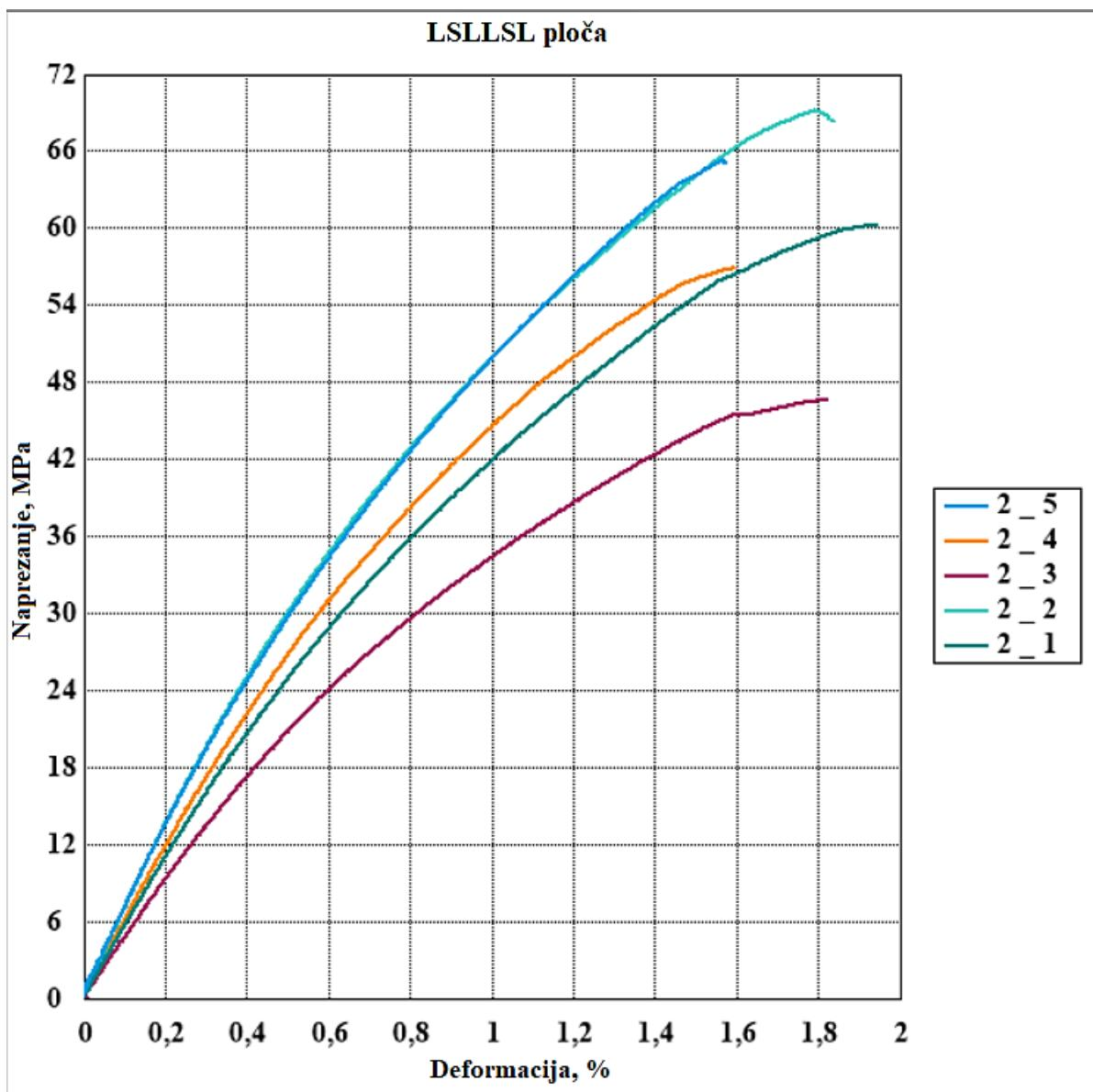
Slika 27. Dijagrami rastezno naprezanje-istezanje za LSLLSL ploču
