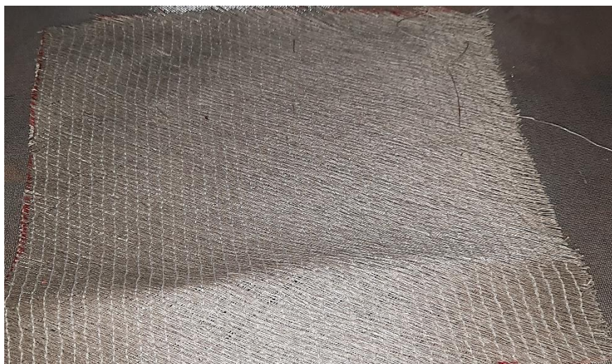
Slika 8. Tkanina lanenih vlakana pod kutom \pm 45^\circ
