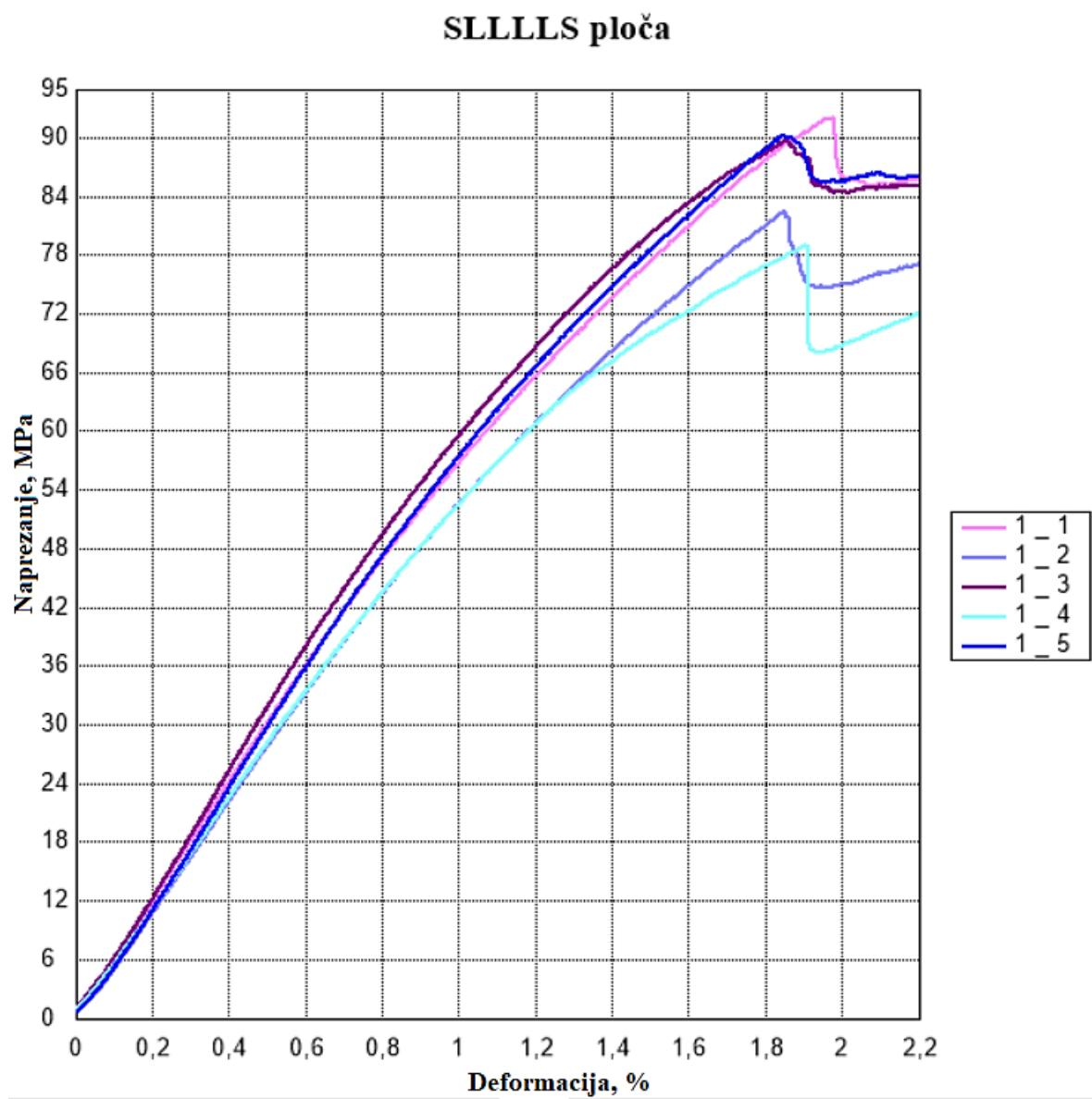
**Slika 32. Dijagrami savojno naprezanje-istezanje za SLLLLS ploču**
