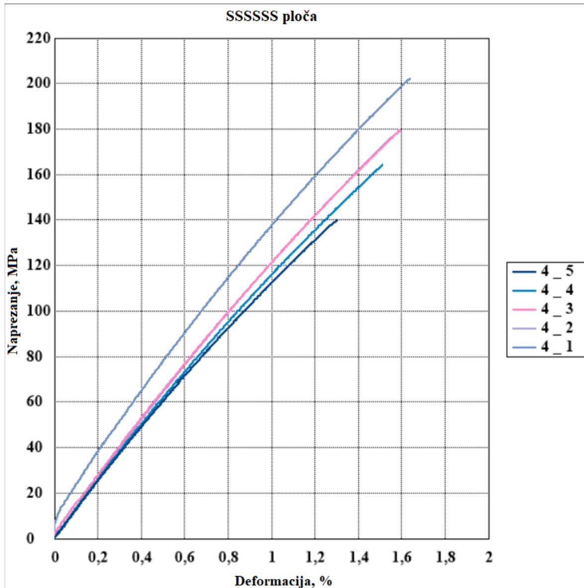
Slika 24. Dijagrami rastezno naprezanje-istezanje za SSSSS ploču
