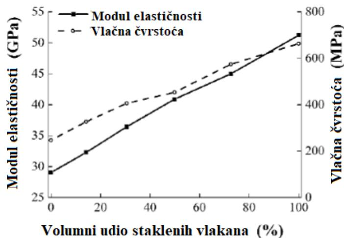
**Slika 5.** Rastezna (vlačna) čvrstoća i modul elastičnosti kompozita s fenolnom matricom ojačani lanenim i staklenim vlknima [9]
