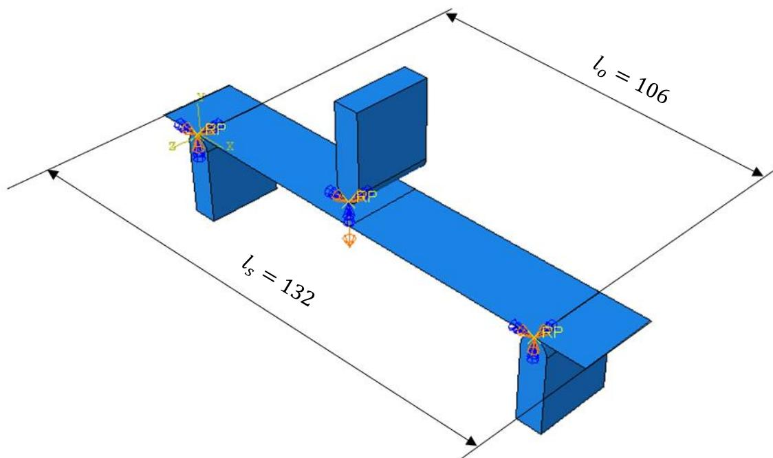
Slika 23. Rubni uvjeti i zadani pomak numeričkog modela za savojno ispitivanje, prikazana je epruveta za lan, dimenzije su u [mm]
