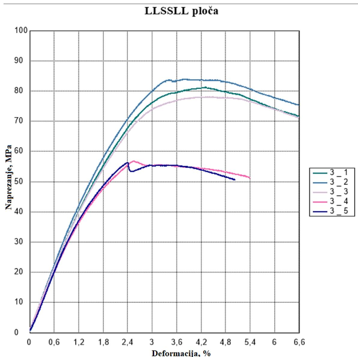
Slika 34. Dijagrami savojno naprezanje-istezanje za LLSSLL ploču
