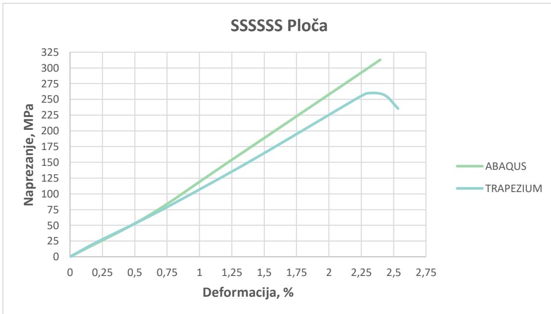
Slika 46. Usporedba dijagrama savojno naprezanje-istezanje u Abaqusu i Trapeziumu za ploču SSSSS
