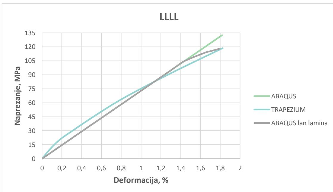
**Slika 48.** Usporedba dijagrama rastezno naprezanje-istezanje u Abaqusu i Trapeziumu za ploču s četiri sloja lanenih vlakana iz literature [40]
