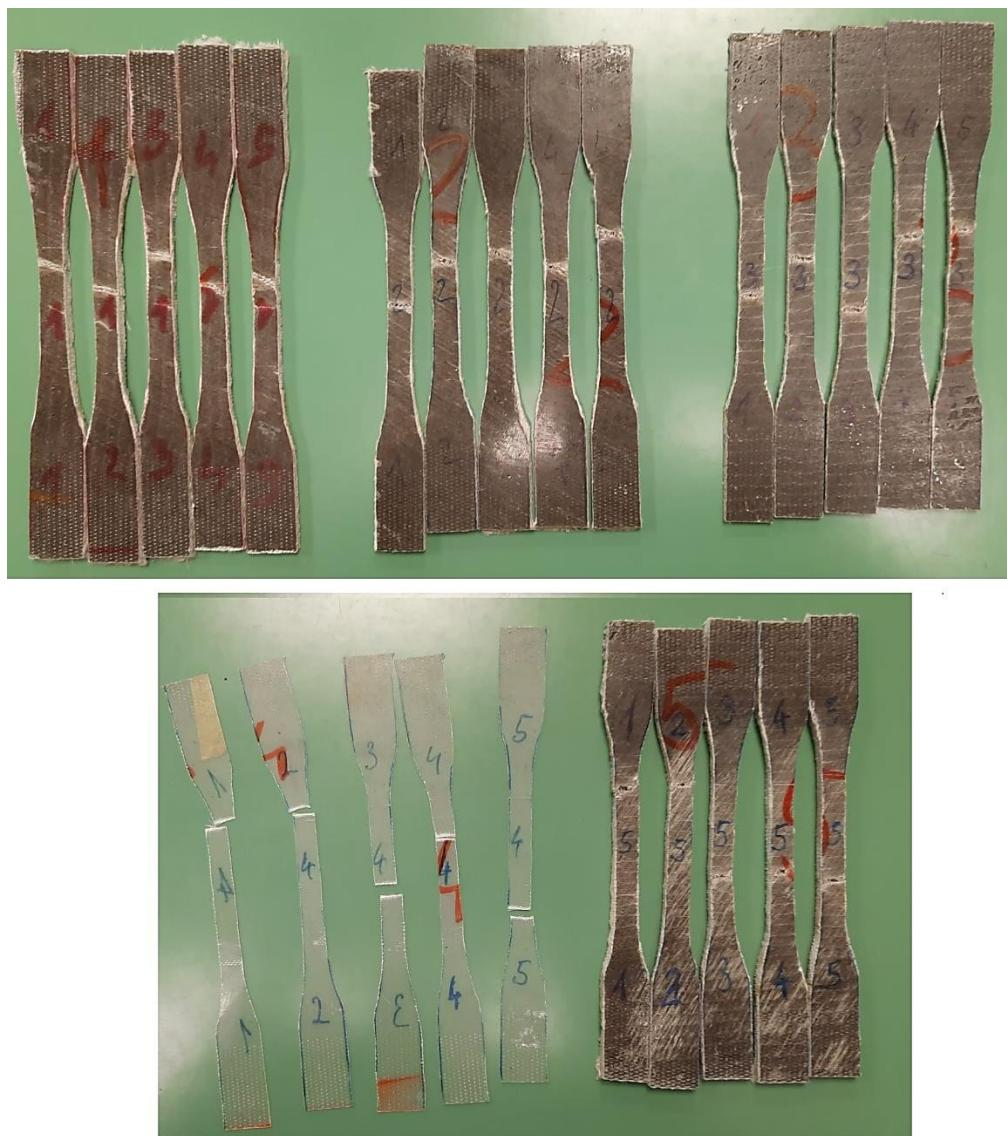
Slika 14. Ispitna tijela nakon provedenog rasteznog ispitivanja
