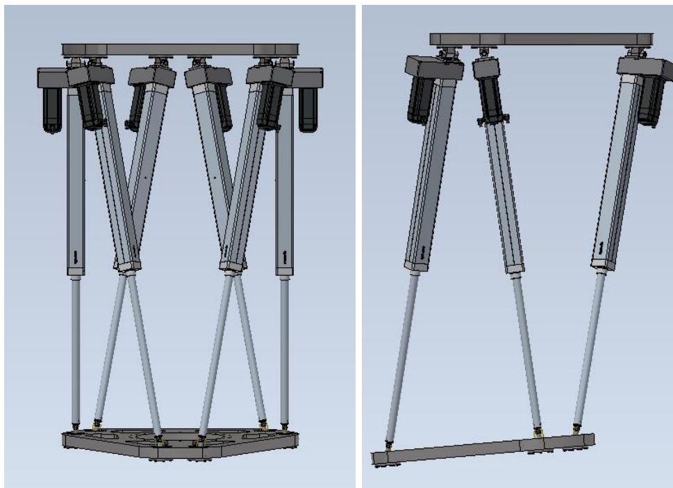
Slika 64. Položaj platforme za FEM analizu nepomične ploče
