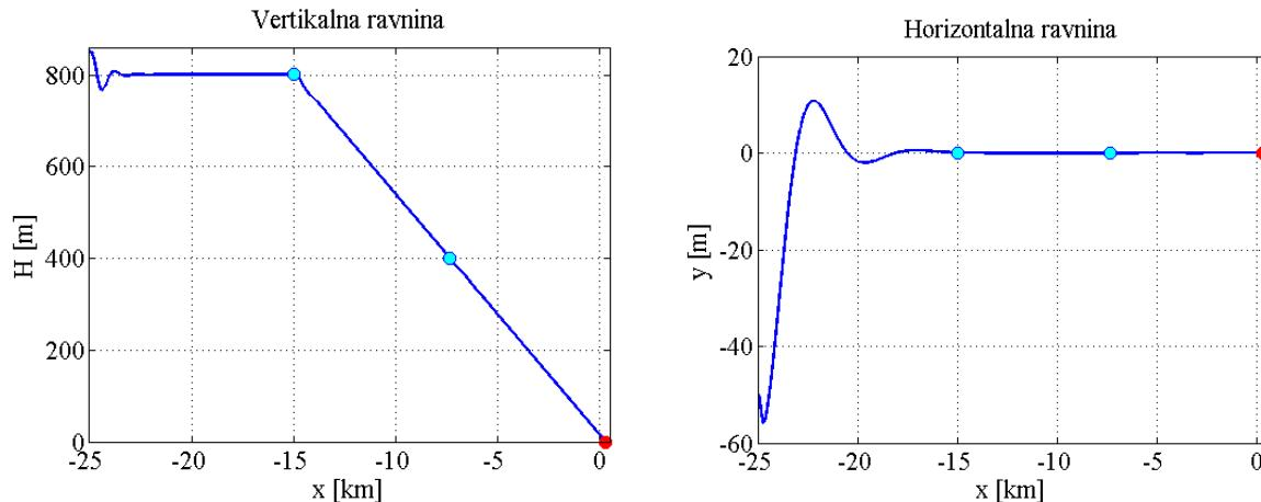
Slika 43. Putanja slijetanja u vertikalnoj i horizontalnoj ravnini
