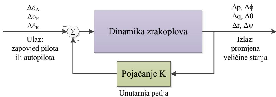
Slika 18. Sustav za povećanje stabilnosti zrakoplova (SAS)
