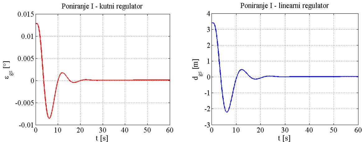
Slika 34. Odziv kutnog i linearног PID regulatora, poniranje I
