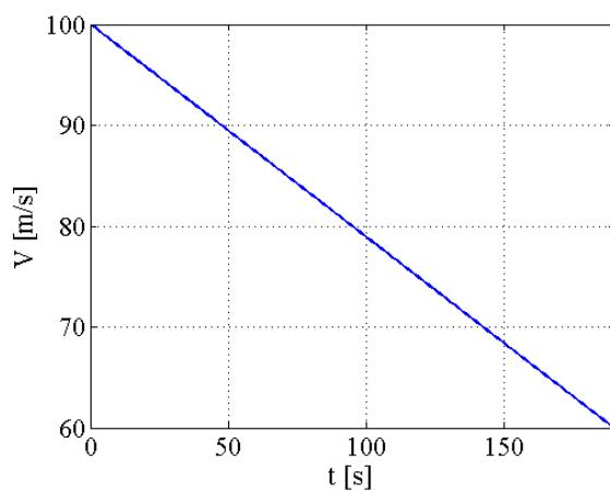
Slika 24. Realna promjena aerodinamičke brzine u poniranju
