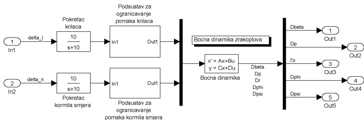
Slika 12. Bočna dinamika zrakoplova, izvedba u Simulinku
