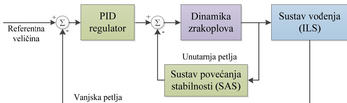
Slika 4. Dijelovi autopilota
