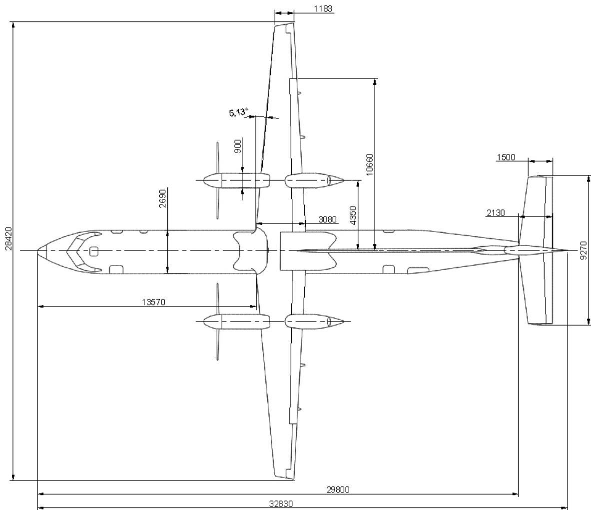
**Slika 6. Tlocrt zrakoplova**
