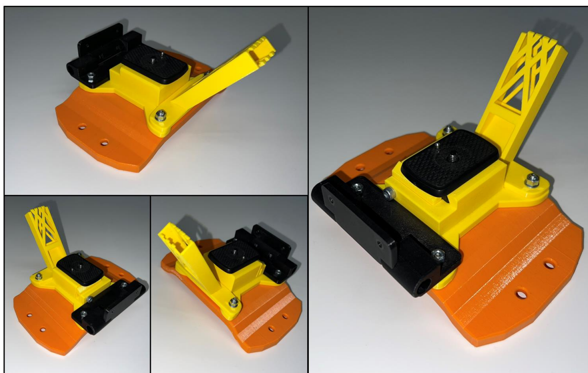
Slika 28. Nosač Intel RealSense D435i kamere postavljena na nosač GNSS prijamnika
