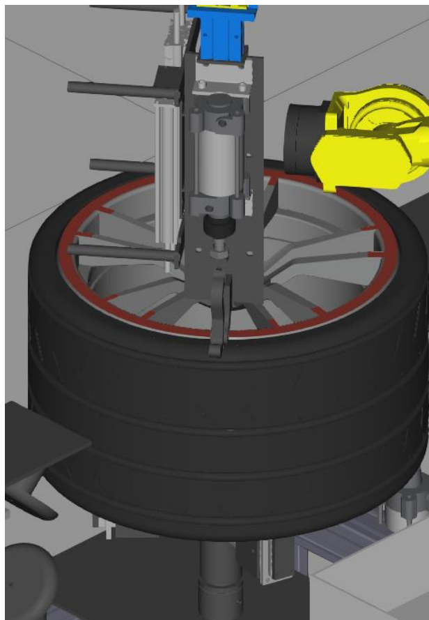
Slika 72. Demontaža gume s kotača
