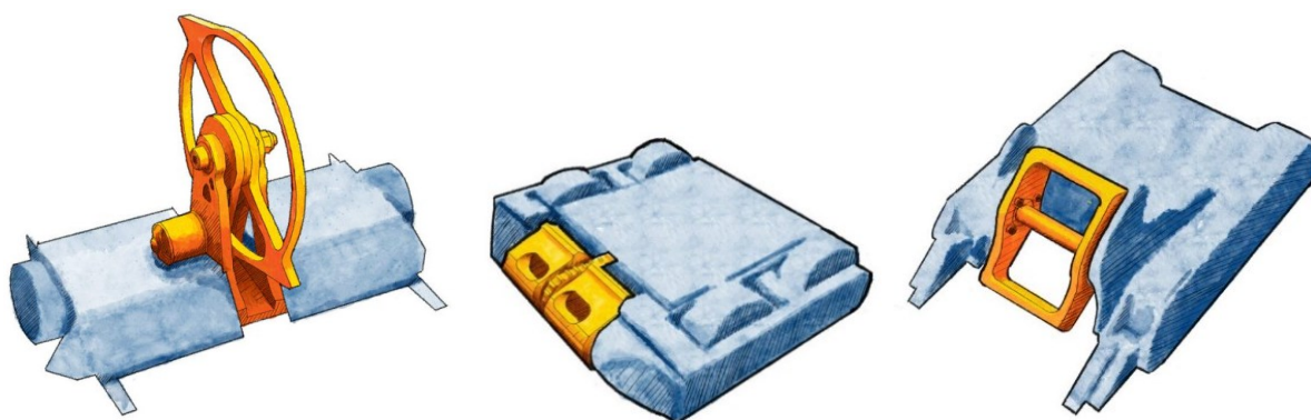
Slika 7. Različite izvedbe vertikalaca, s lijeva nadesno: disc, drum, eggbeater
