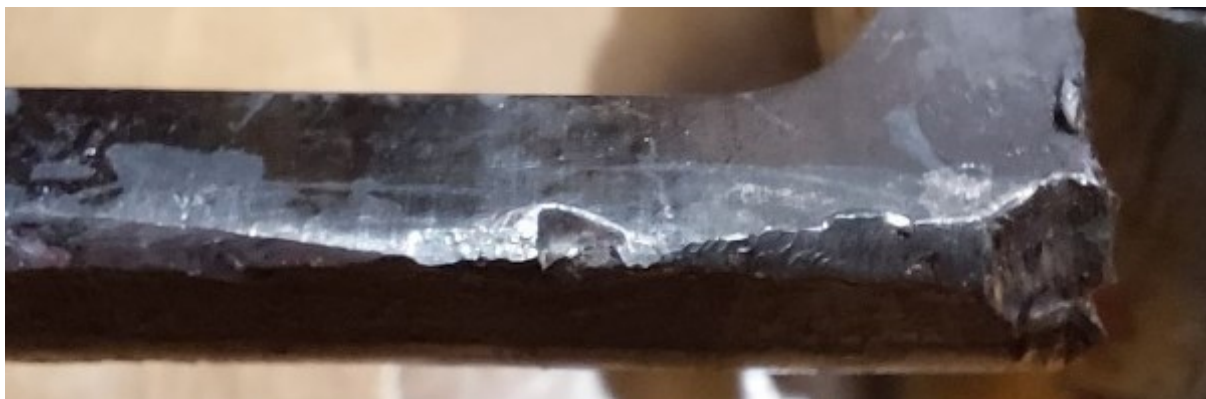
Slika 30. Detalj otkrhnute oštrice s Eggsecutionera_V3
